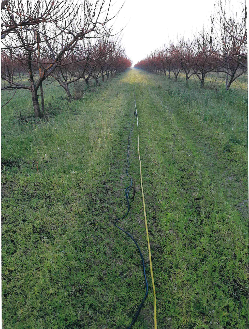
Esecuzione profilo Masw SE
