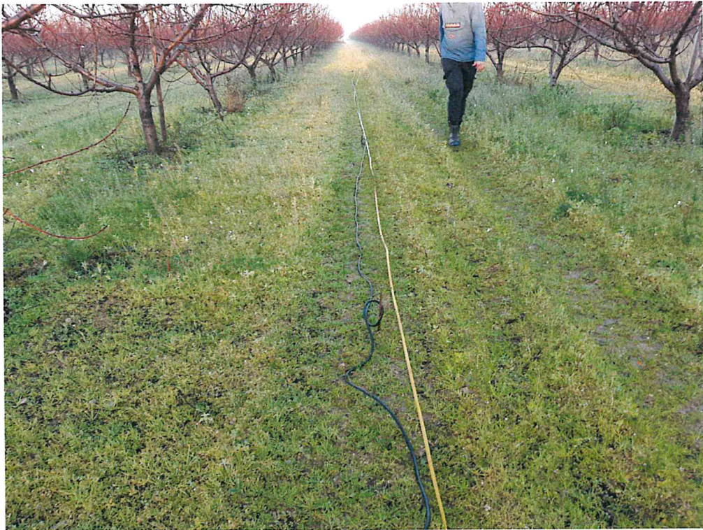
Esecuzione profilo Masw SE
