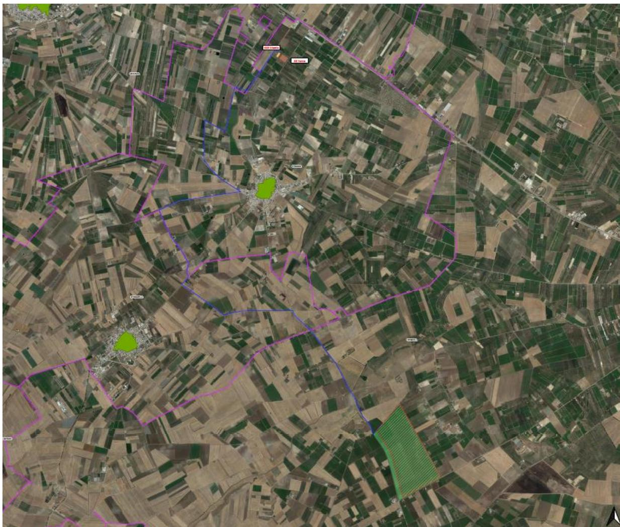
**Fig. 1 - Inquadramento generale su Ortofoto, in verde le aree di impianto ANaV, in blu il cavidotto a 30 kV, in arancio la Sottostazione elettrica Utente**
