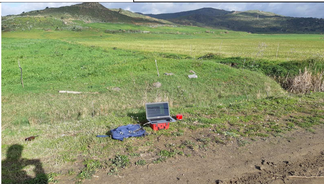
Indagine geofisica tramite tecnica HVSR
