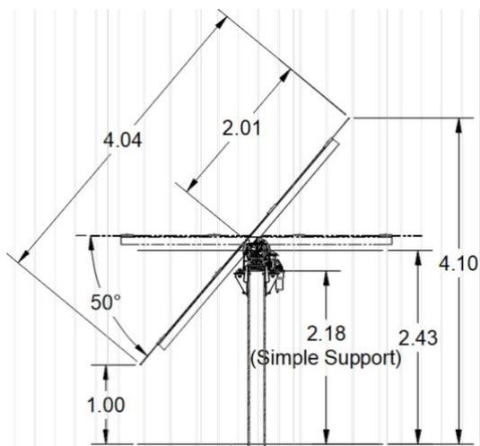
Figura 2 modulo tracker – vista laterale
