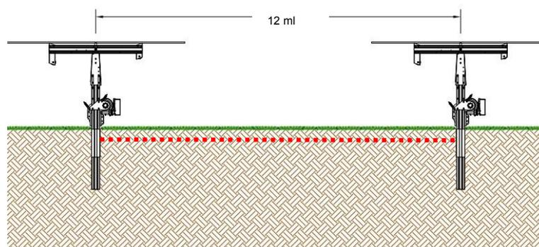
**Figura 7 – Distanza tra le singole file (tracker) di moduli fotovoltaici con indicazione della superficie che può essere utilizzata per la messa a coltura di prato stabile (linea tratteggiata rossa).**
