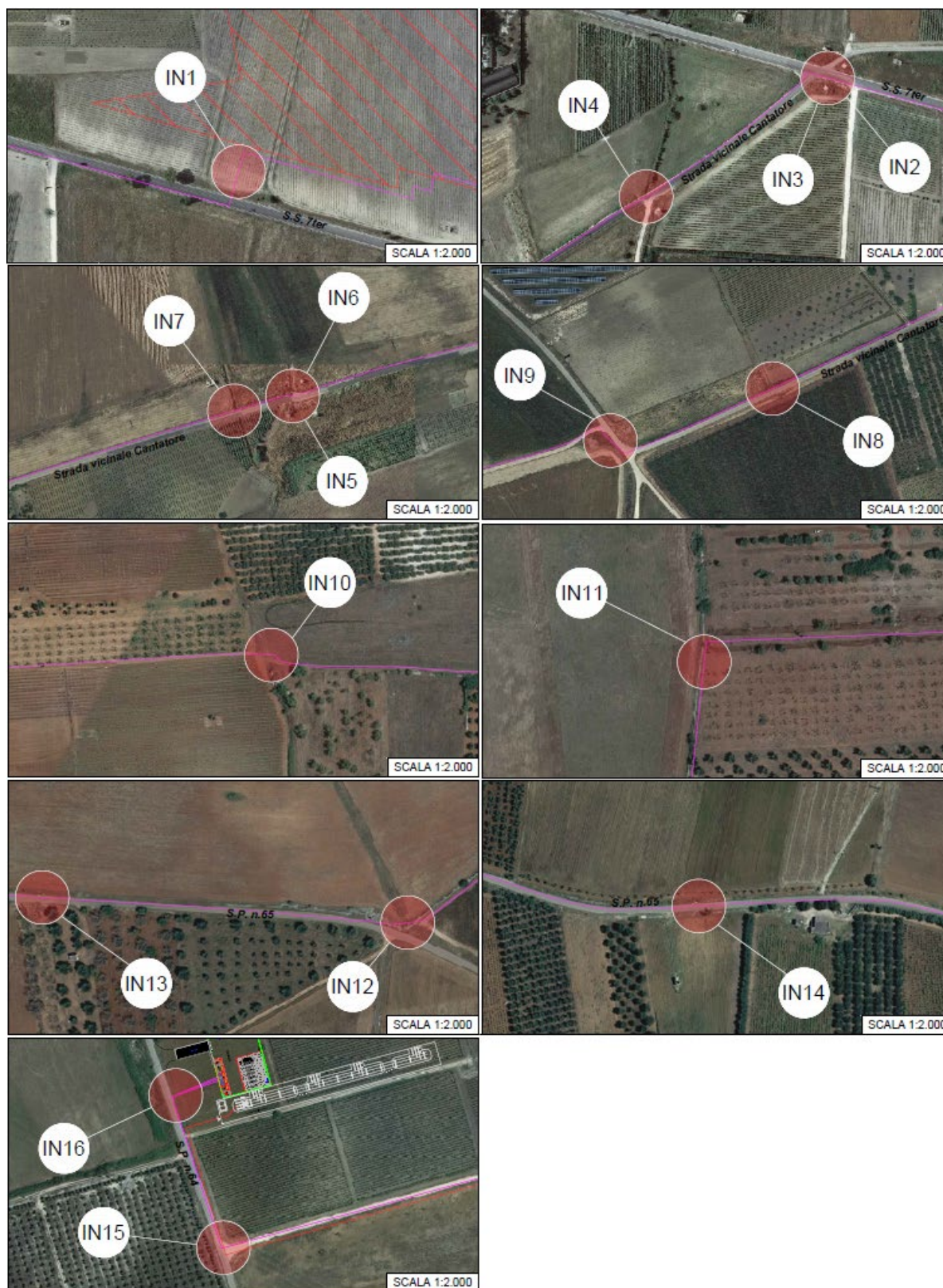
Figura 5 - Interferenze del cavidotto M.T. con sottoservizi esistenti
