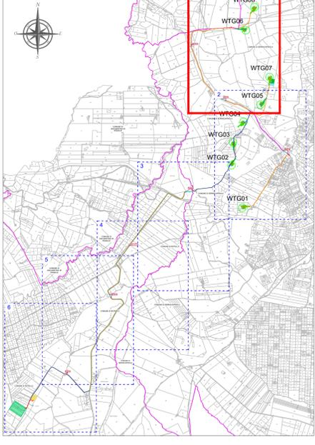
Schema di collegamento WTG e lunghezza del tracciato dei cavidotti MT
