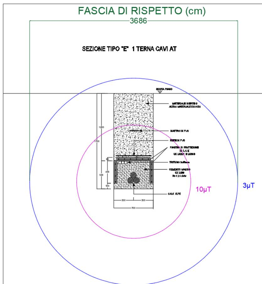
Figura 13: Curve Equicampo -1 Terna cavi AT (su strada sterrata)
