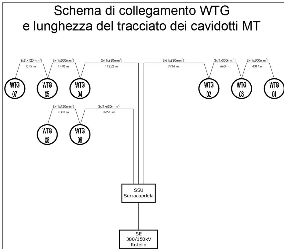
**Figura 1 - Schema di collegamento tra WTG - SSU - SE**
