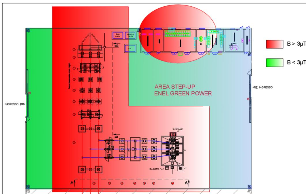
Figura 12: Limiti di esposizione all'interno dell'area della SSU 150/30 kV
