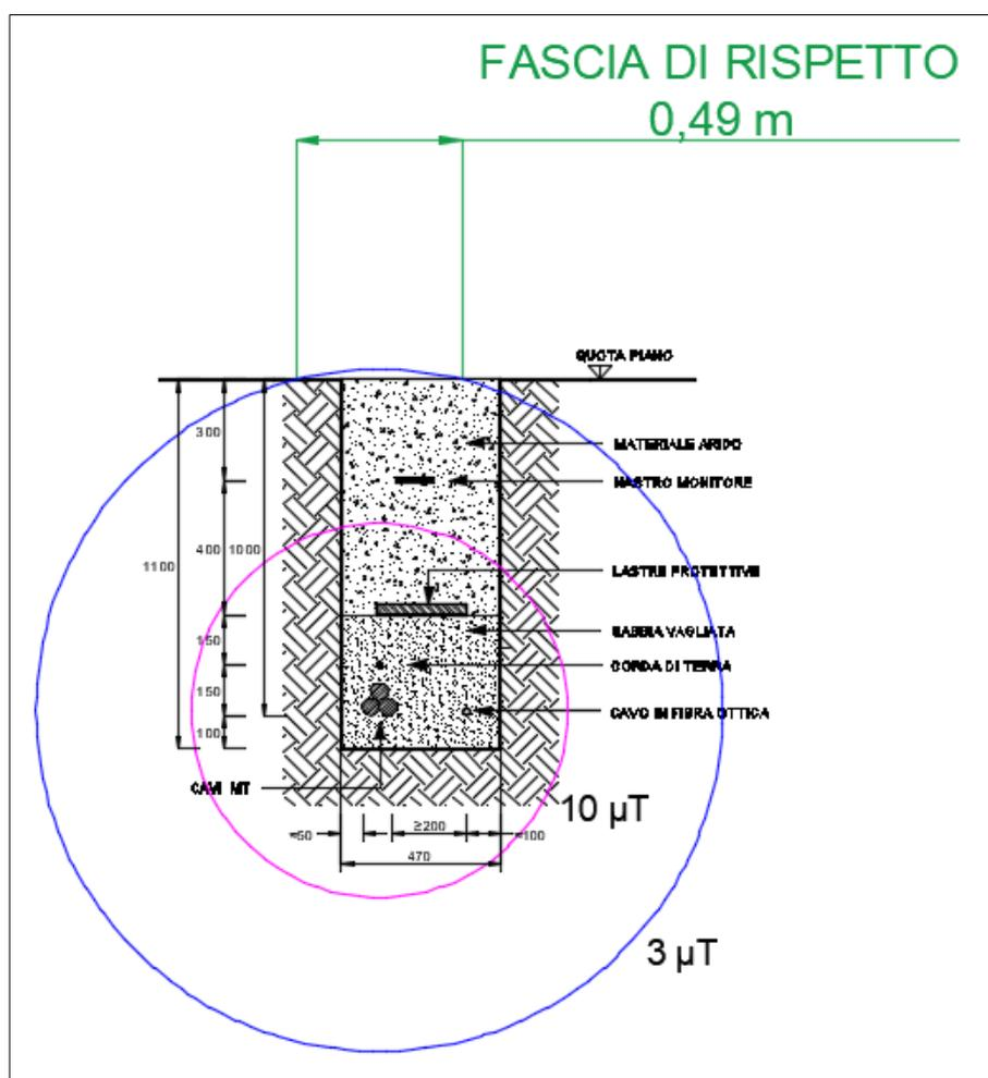
**Figura 6: Curve Equicampo –Una Terna cavi MT – Tratta 2 (su strada sterrata)**
