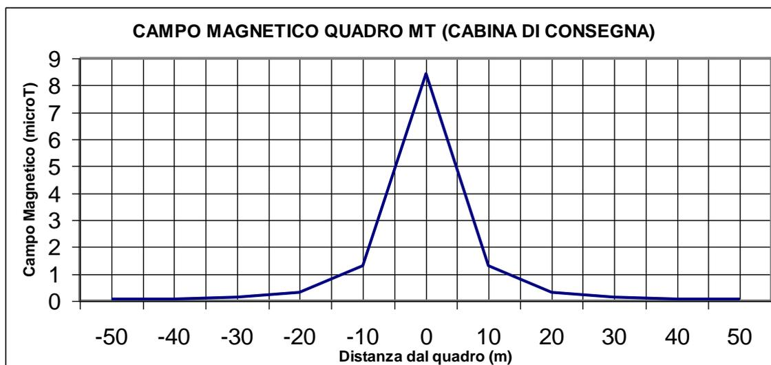
Le sbarre principali del quadro saranno dimensionate per la corrente nominale pari a 1250 A, mentre quelle in derivazione per la corrente nominale pari a 630 A, il raggiungimento dell'obiettivo di qualità si ottiene a circa 7 metri di distanza dal quadro oggetto di verifica preliminare.
