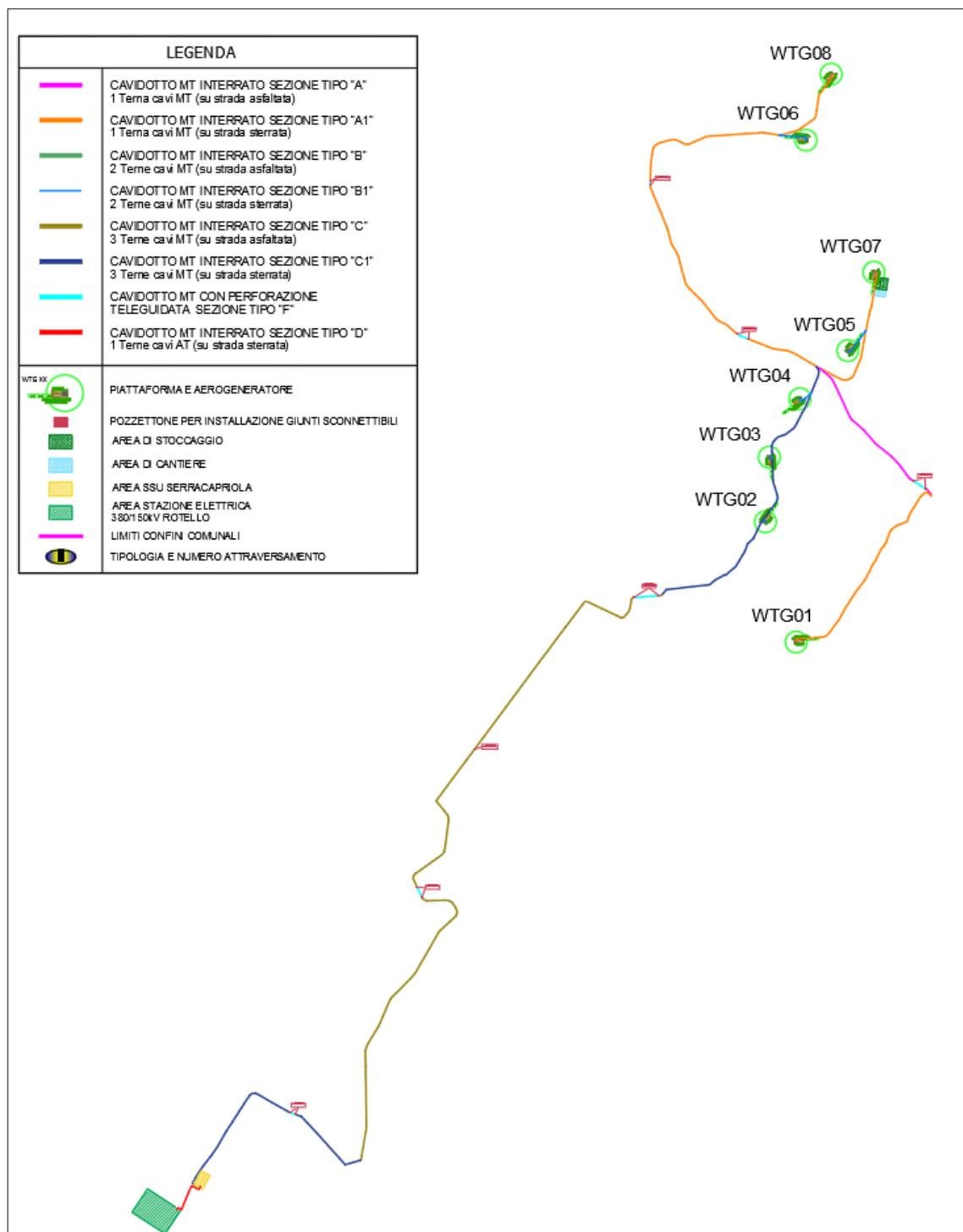
**Figura 3: Caratteristiche cavi MT interno/esterno parco**
