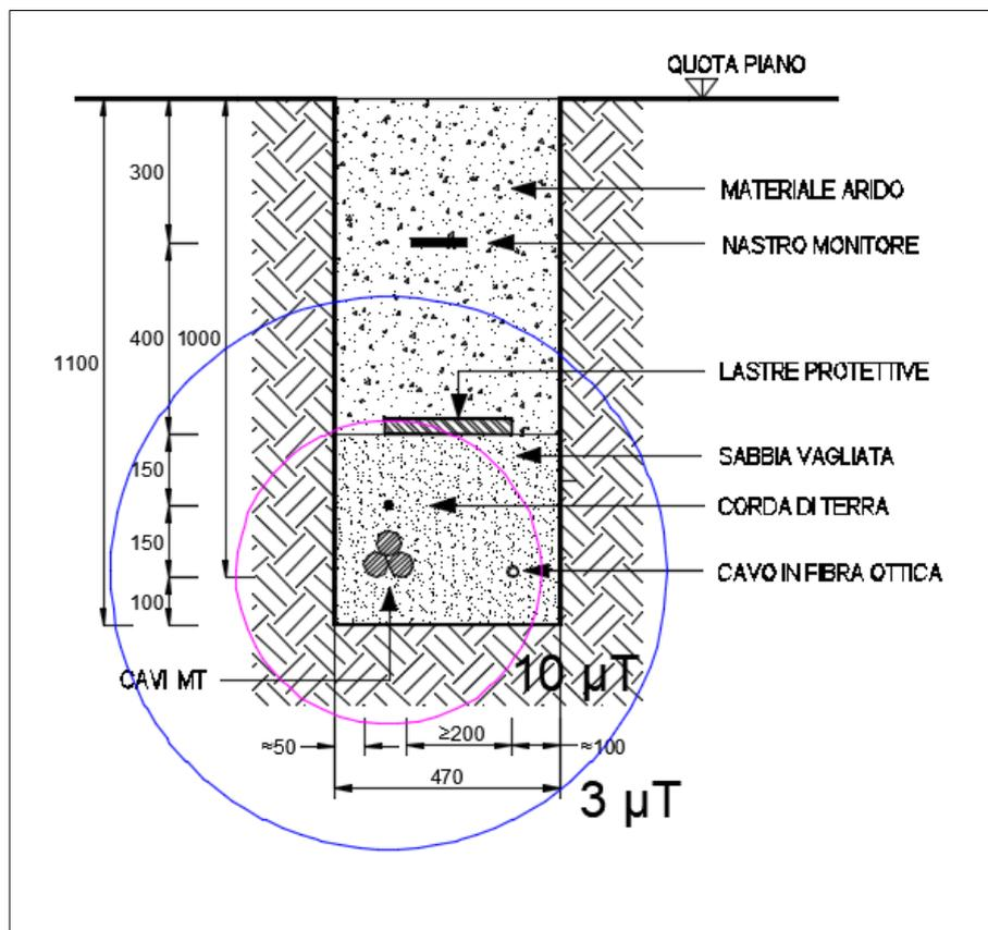
**Figura 5: Curve Equicampo -Una Terna cavi MT - Tratta 1(su strada sterrata)**
