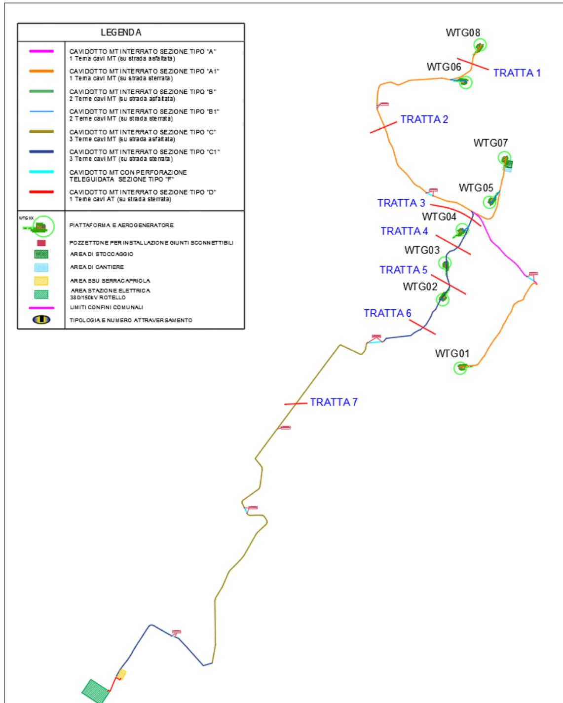
**Figura 4: Tratte del percorso dei cavidotti MT per la valutazione dei campi magnetici**
