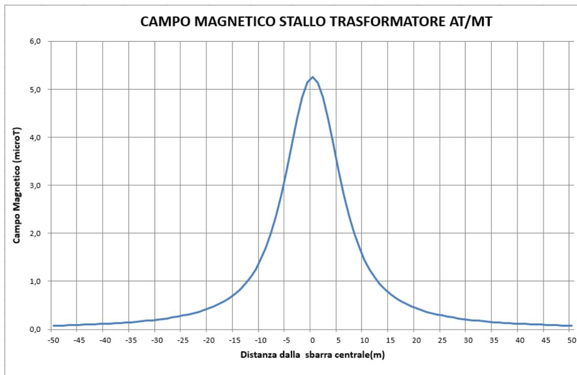
In particolare, l'andamento del campo magnetico in funzione della distanza dall'asse delle sbarre di AT in aria, evidenzia che la corrispondente  $D_{pa}$ , di 5 metri circa, ricade all'interno dell'area di Stazione, in quanto l'asse delle sbarre si trova ad una distanza dal perimetro esterno maggiore della  $D_{pa}$ .
