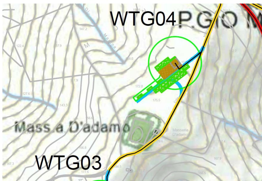
Figura 21 - Attraversamento fascia di rispetto area boscata esistente tra WTG04 e WTG03 su strada esistente
