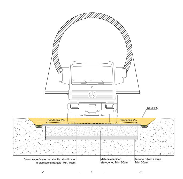
Sezione tipologica per i tratti viari di nuova costruzione, principalmente di accesso alle piazzole di progetto degli aerogeneratori.
