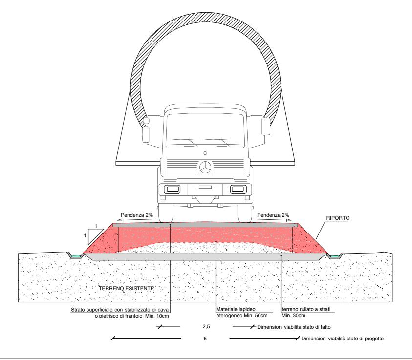
Sezione tipologica per i tratti viari da adeguare, principalmente di connessione tra la viabilità di nuova costruzione e la viabilità esistente.
