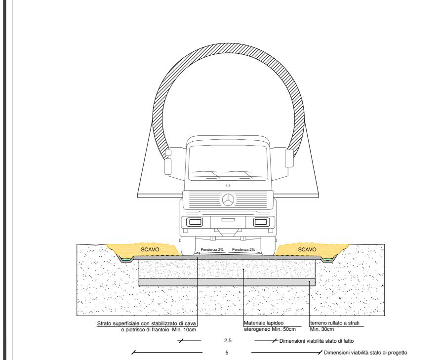
Sezione tipologica per i tratti viari di da adeguare, principalmente di connessione tra la viabilità esistente e la viabilità di nuova costruzione.
