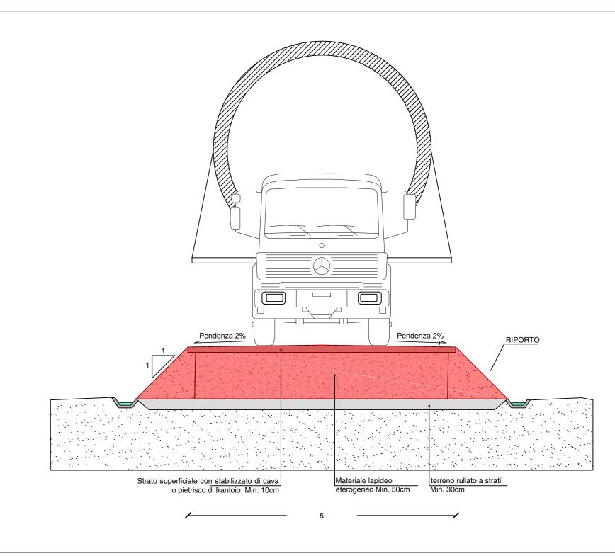
Sezione tipologica per i tratti viari di nuova costruzione, principalmente di accesso alle piazzole di progetto degli aerogeneratori.
