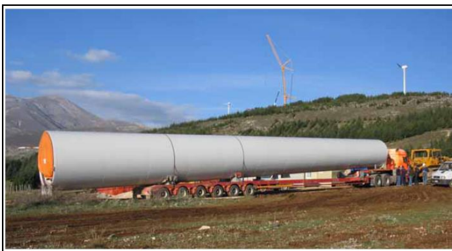
Figura 22 - Foto del trasporto di un concio di turbina
