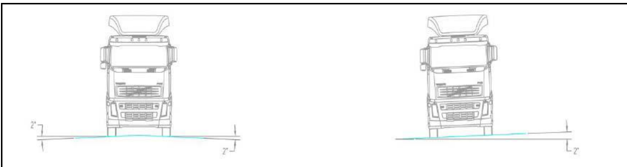
Figura 20 - Andamento delle pendenze dello strato superficiale
