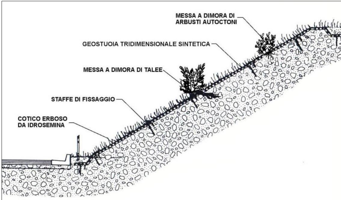
Figura 5 - Esempio schematico di rivestimento in geostuoia
