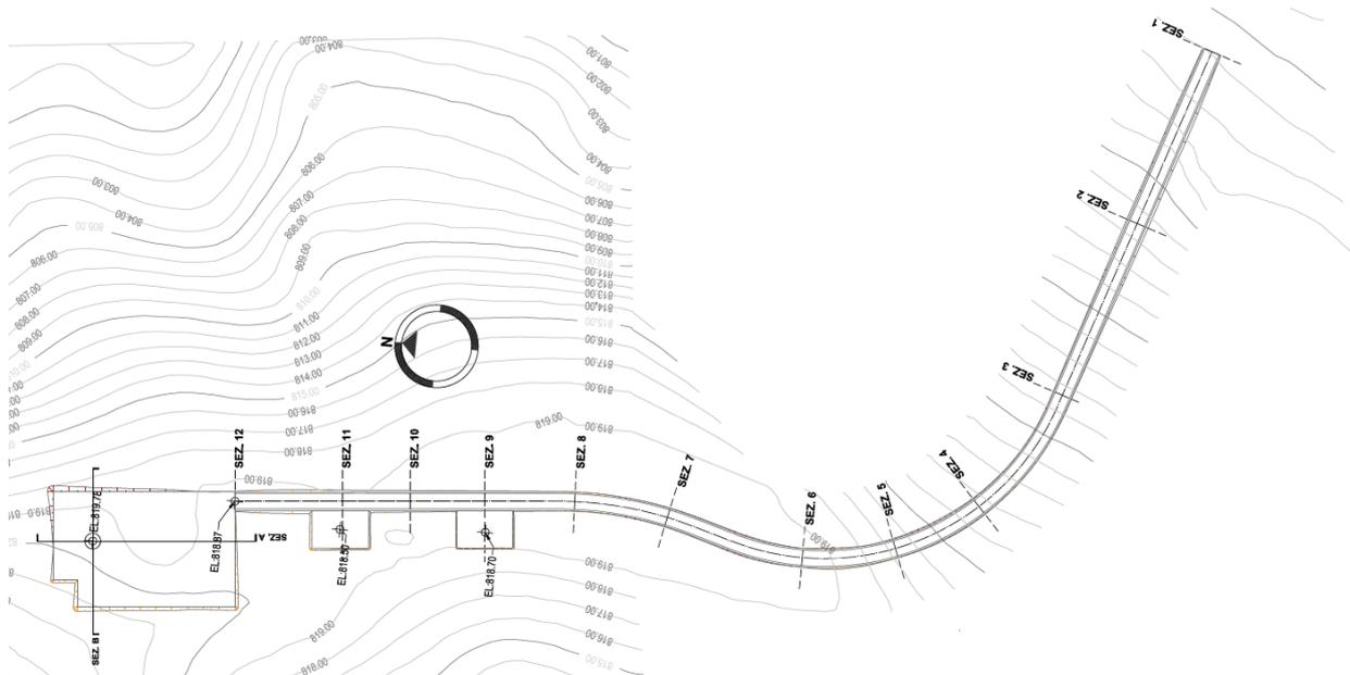
Figura 22-Planimetria del ramo 4 e della piazzola relativa alla turbina CA04
