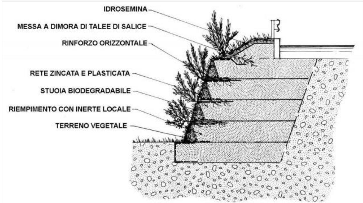
Figura 10 - Esempio schematico di terre rinforzate
