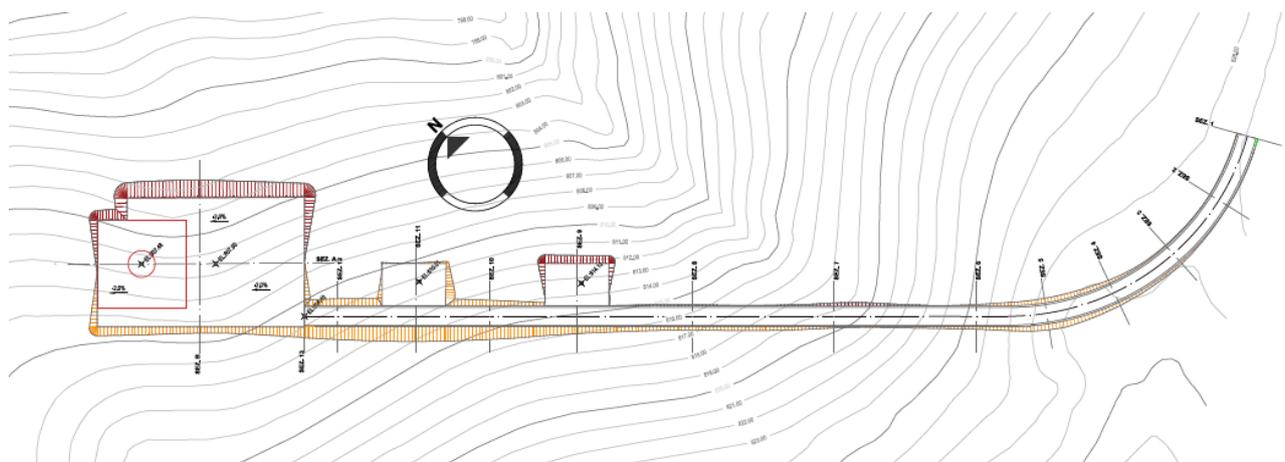
Figura 15 – Planimetria del ramo 1 e della piazzola relativa alla turbina CA01
