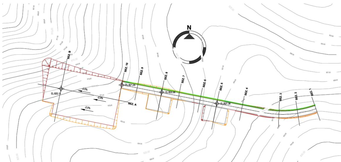
**Figura 28 - Planimetria del ramo 7 e della piazzola relativa alla turbina CA07**
