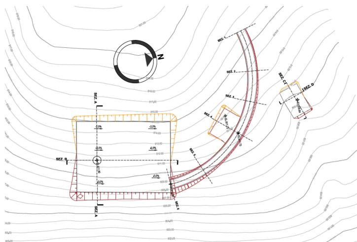
Figura 20 –Zoom della planimetria del ramo 3 e della piazzola relativa alla turbina CA03
