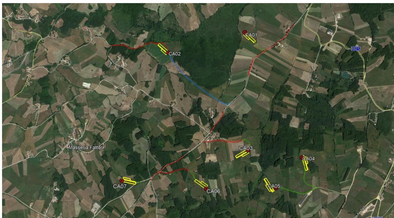
**Figura 2 - Layout di progetto - Piazzole (giallo), viabilità di nuova realizzazione (verde) e viabilità da adeguare (rosso) e viabilità temporanea (blu)**
