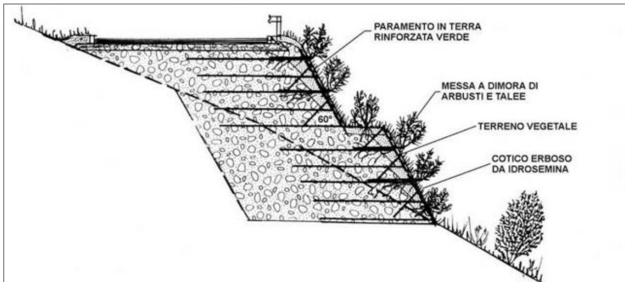
Figura 9 - Esempio schematico di terre rinforzate
