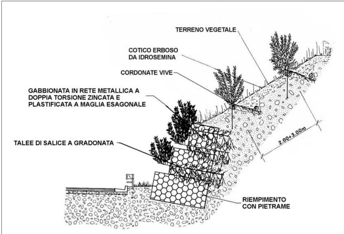
Figura 7 - Esempio schematico di gabbionate rinverdite
