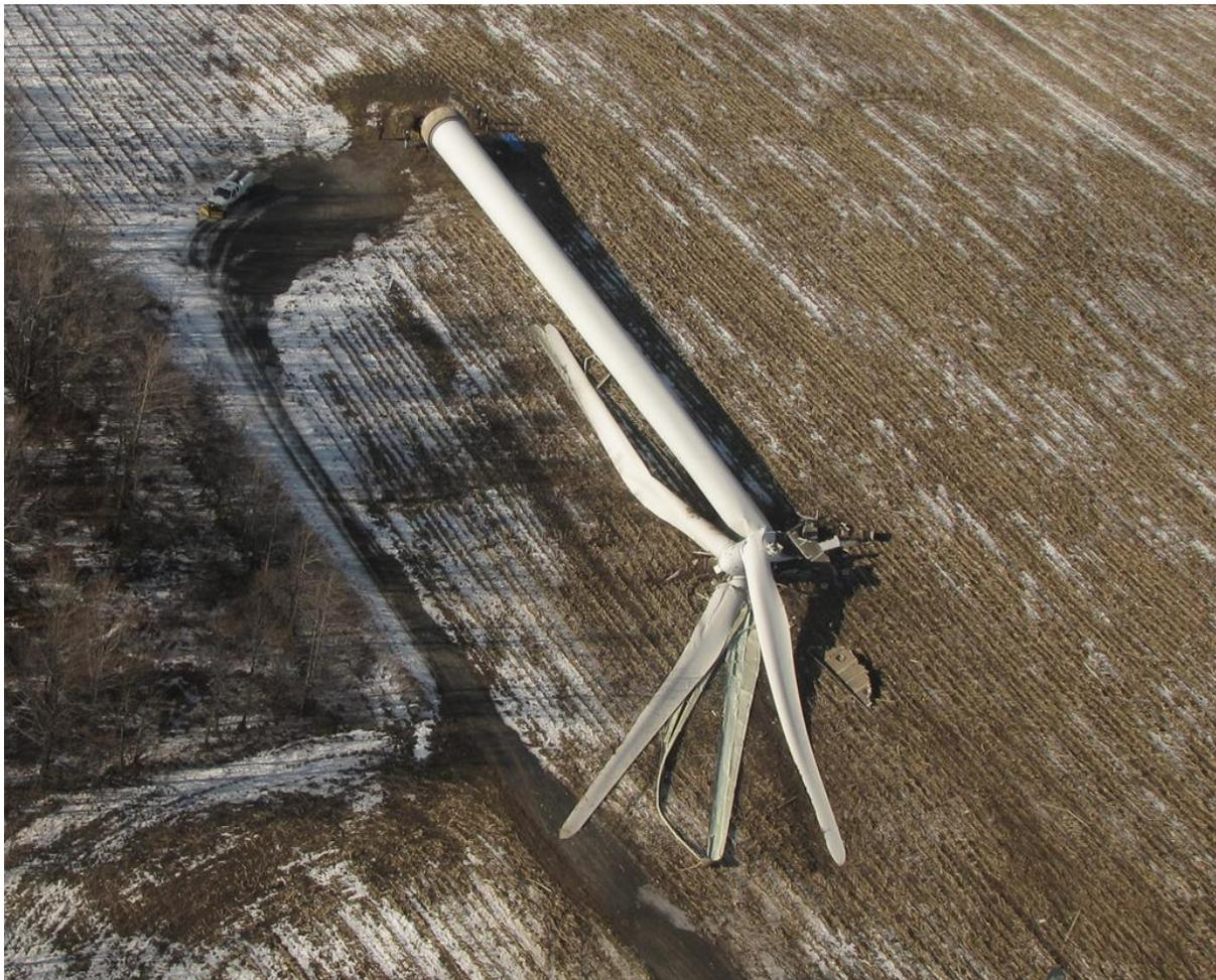
**Figura 4 - Rovesciamento completo dell'insieme turbina-fondazione**
