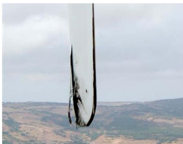
Figura 13 estremità di pala danneggiata da fulminazione atmosferica
