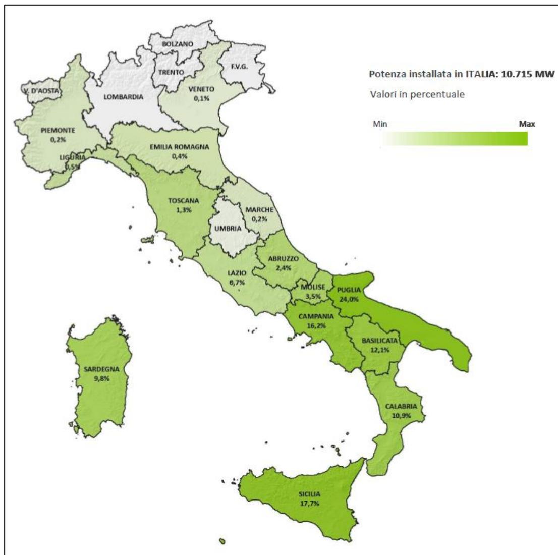
Figura 20 – Distribuzione regionale della **potenza** installata degli impianti eolici a fine 2019 (Fonte: Terna).
