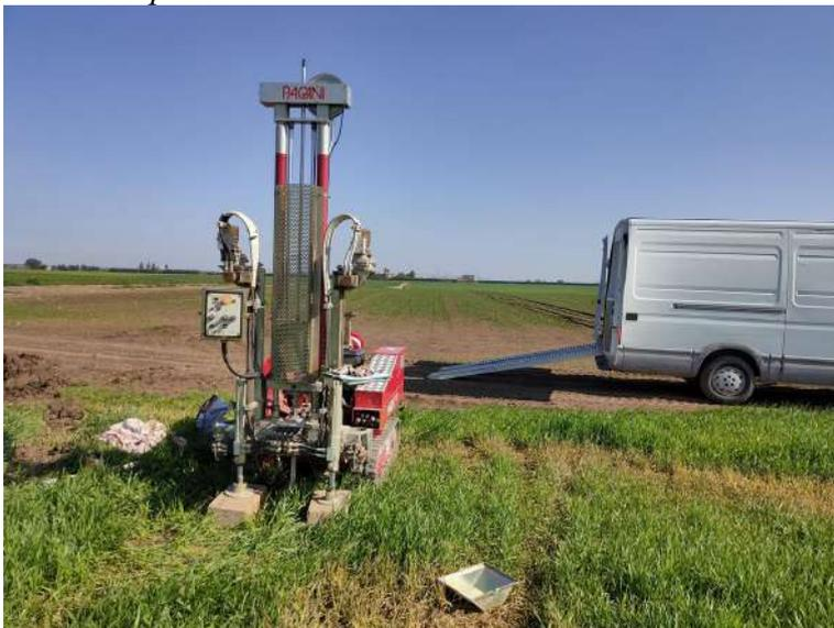
*Prova penetrometrica dinamica continua DPSH n.4*
