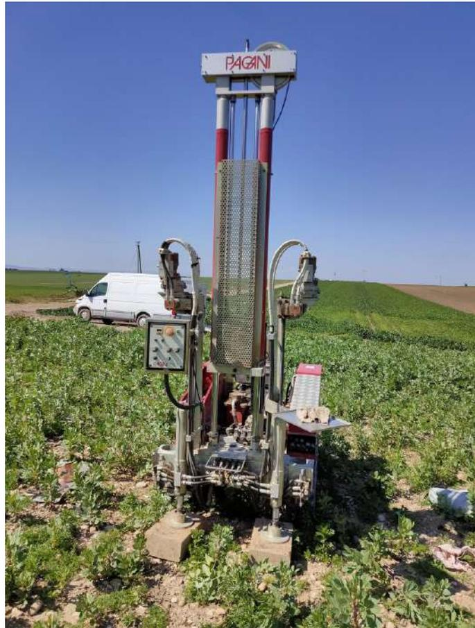
*Prova penetrometrica dinamica continua DPSH n.2*
