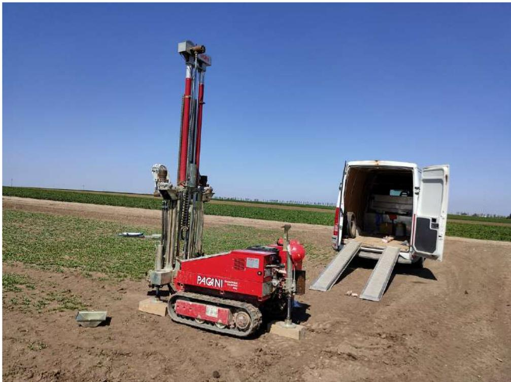
*Prova penetrometrica dinamica continua DPSH n.3*
