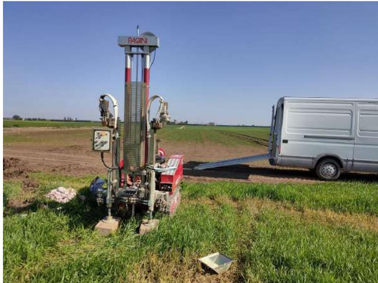
*Prova penetrometrica dinamica continua DPSH n.4*
