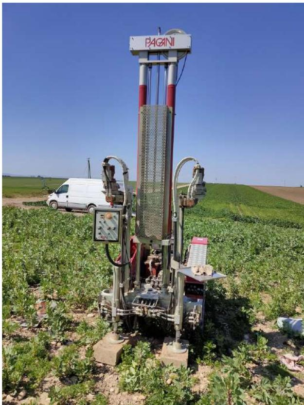
*Prova penetrometrica dinamica continua DPSH n.2*
