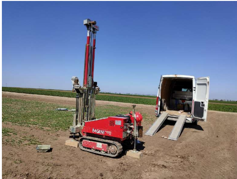
Prova penetrometrica dinamica continua DPSH n.3
