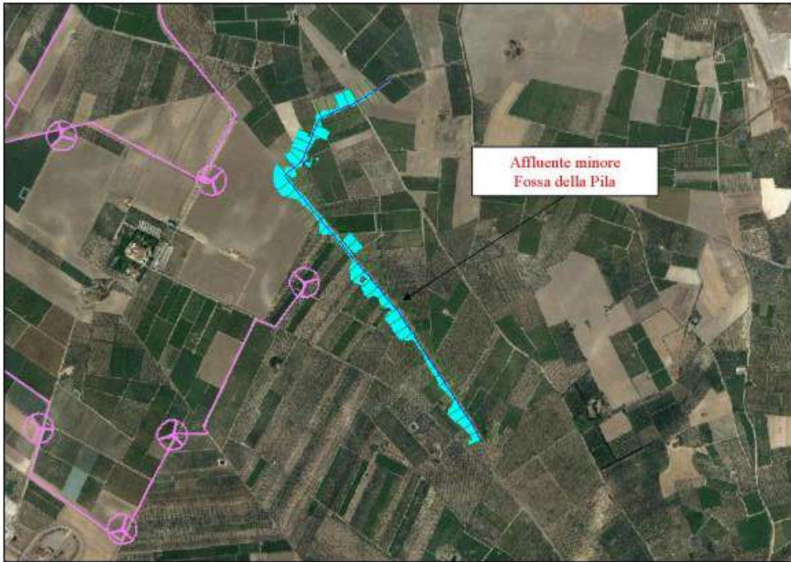
Tavola 5: Affluente minore Fossa della Pila - Planimetria con individuazione delle sezioni e delle aree potenzialmente interessate dalla portata avente tr = 200 anni
