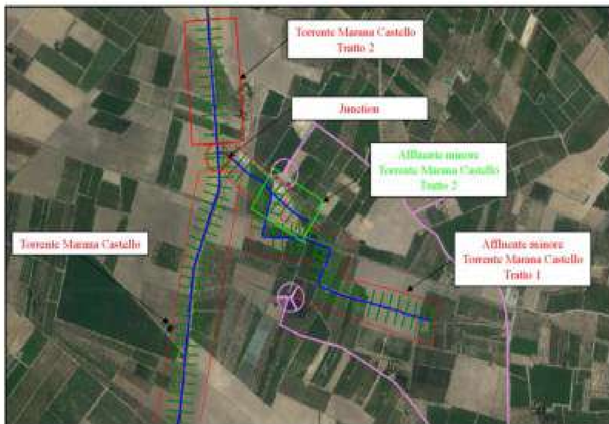
Tavola 1: Schema del modello in HEC-RAS del Torrente Marana Castello con indicazione del punto di giunzione
