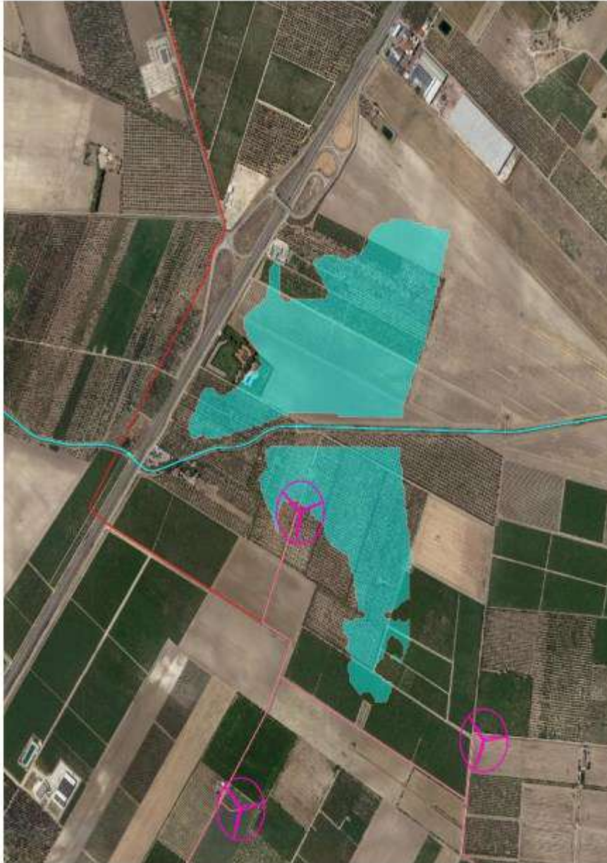
Tavola 7: Planimetria Torrente Marana Castello - primo segmento con individuazione delle sezioni e delle aree potenzialmente interessate dalla portata avente tr = 200 anni e con il risultato della modellazione bidimensionale (tratteggio verde)
