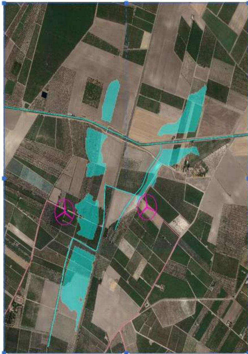
Tavola 8: Planimetria Torrente Marana Castello – secondo e terzo segmento e Affluente minore Torrente Marana Castello con individuazione delle sezioni e delle aree potenzialmente interessate dalla portata avente tr = 200 anni e con il risultato della modellazione bidimensionale (tratteggio verde)
