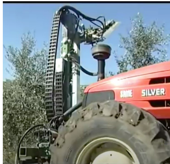
Figure 4-7. Esempio di potatrice meccanica frontale a doppia barra (taglio verticale + topping) utilizzabile su tutti le colture arboree intensive e superintensive.
