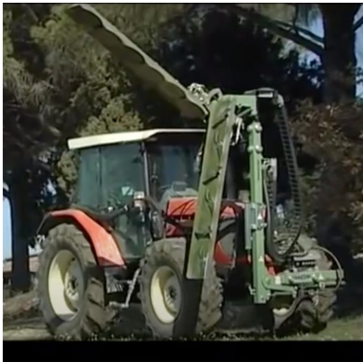
Figure 4-7. Esempio di potatrice meccanica frontale a doppia barra (taglio verticale + topping) utilizzabile su tutti le colture arboree intensive e superintensive.
