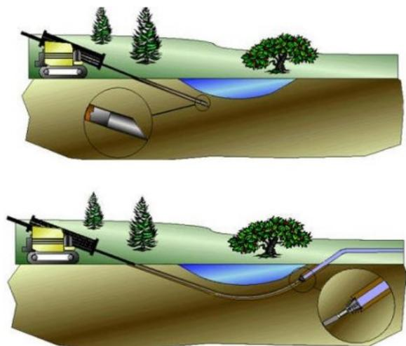
Provinciali SP95 e SP83 e la Strada Vicinale "Schiavone"; lungo la SP83 è presente un canale d'acqua il cui attraversamento sarà possibile applicando la tecnica del "no dig" o "perforazione teleguidata" che permette la posa in opera di tubazioni e cavi interrati senza ricorrere agli scavi a cielo aperto e senza compromettere il naturale flusso degli stessi corsi d'acqua. Di seguito un'immagine esplicativa della tecnica prevista.
