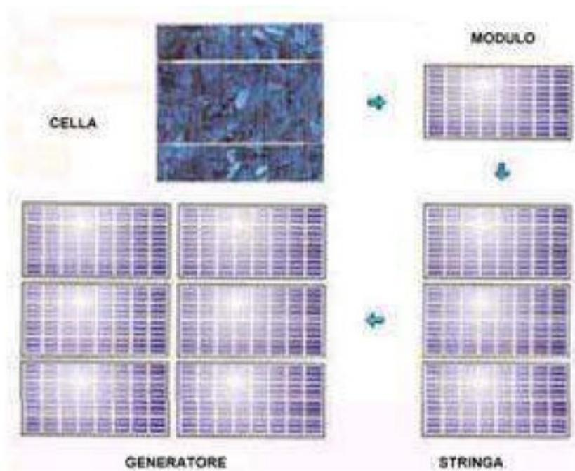
Figure 2-3. Struttura impianto fotovoltaico
