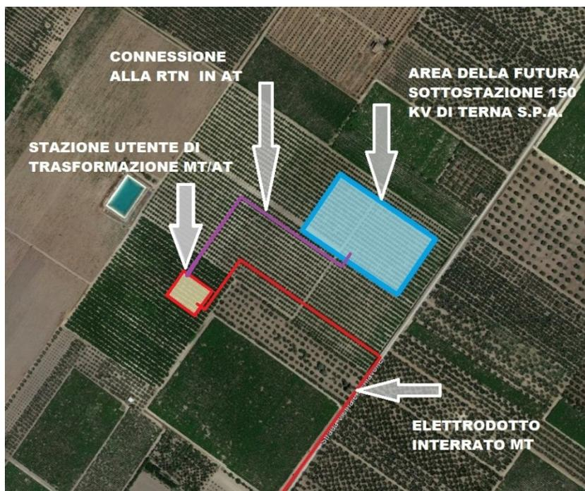
Figure 2-4. Vista d'insieme della stazione utente di trasformazione MT/AT.
