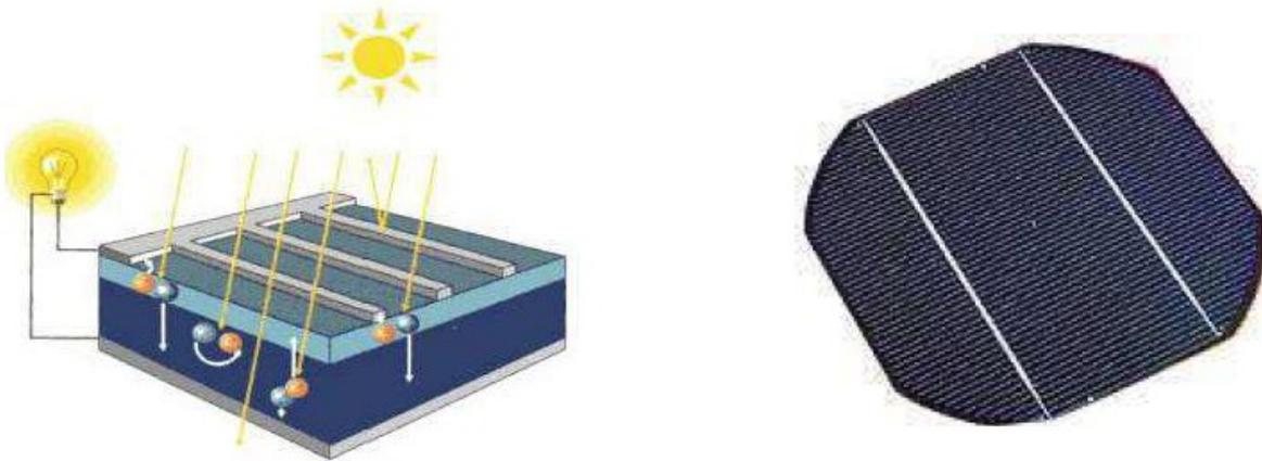
Figure 2-2. Schema di funzionamento e immagine di una cella fotovoltaica
