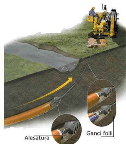
Questo tipo di perforazione consiste essenzialmente nella realizzazione di un cavidotto sotterraneo mediante il radio-controllo del suo andamento plano-altimetrico. Il controllo della perforazione è reso possibile dall'utilizzo di una sonda radio montata in cima alla punta di perforazione, questa sonda dialogando con l'unità operativa esterna permette di controllare e correggere in tempo reale gli eventuali errori.
