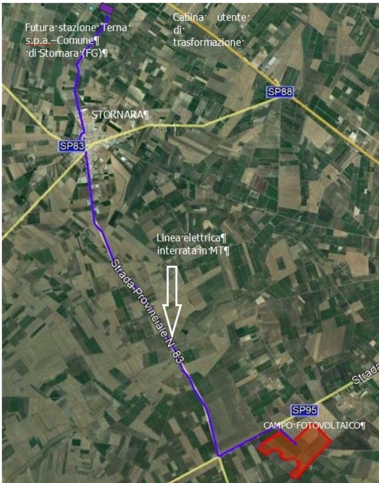
Figure 2-5. Vista d'insieme dell'impianto con collegamento cavo MT (in blu)
