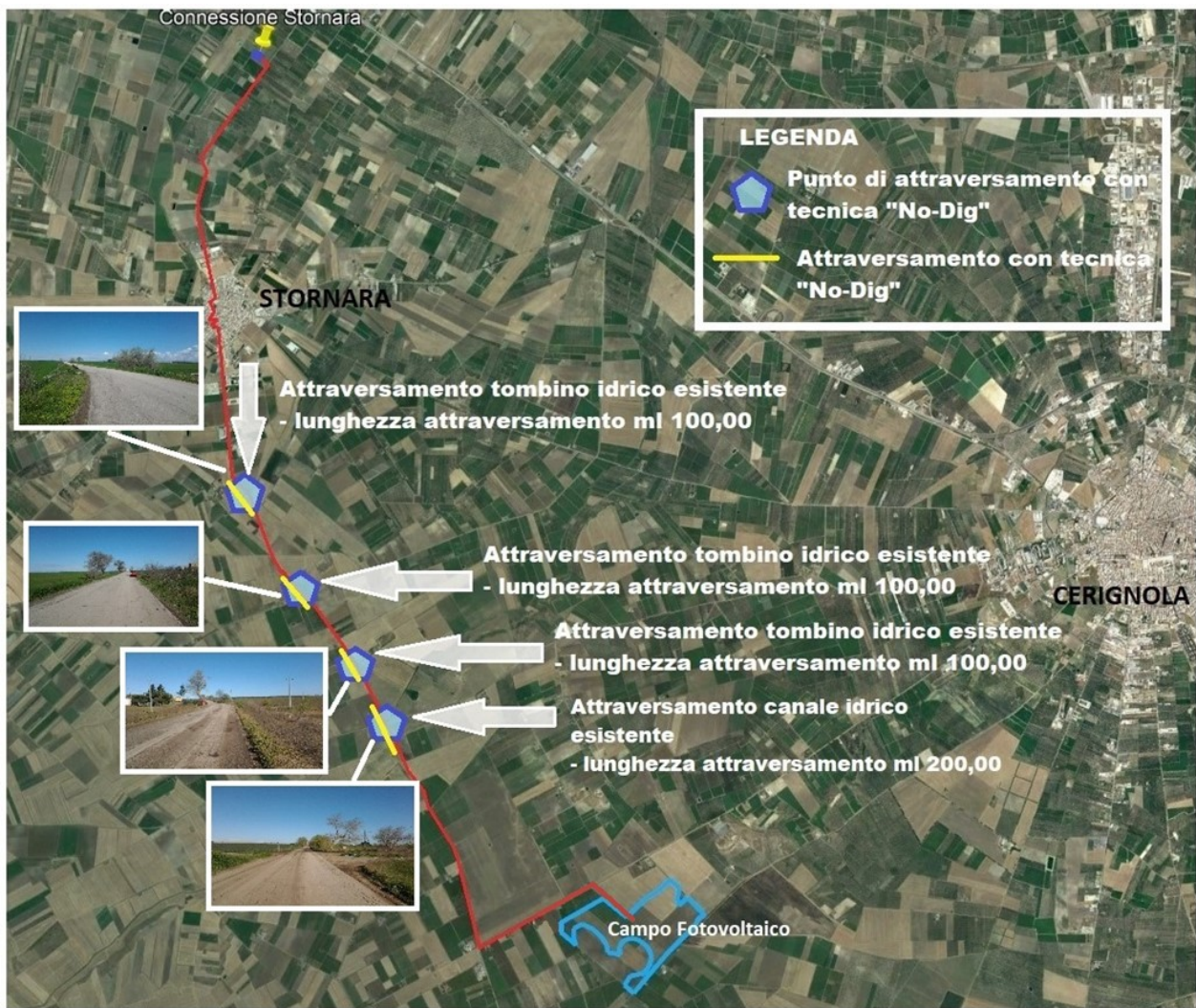
Figure 3-12. Il directional drilling rappresenta sicuramente la più
