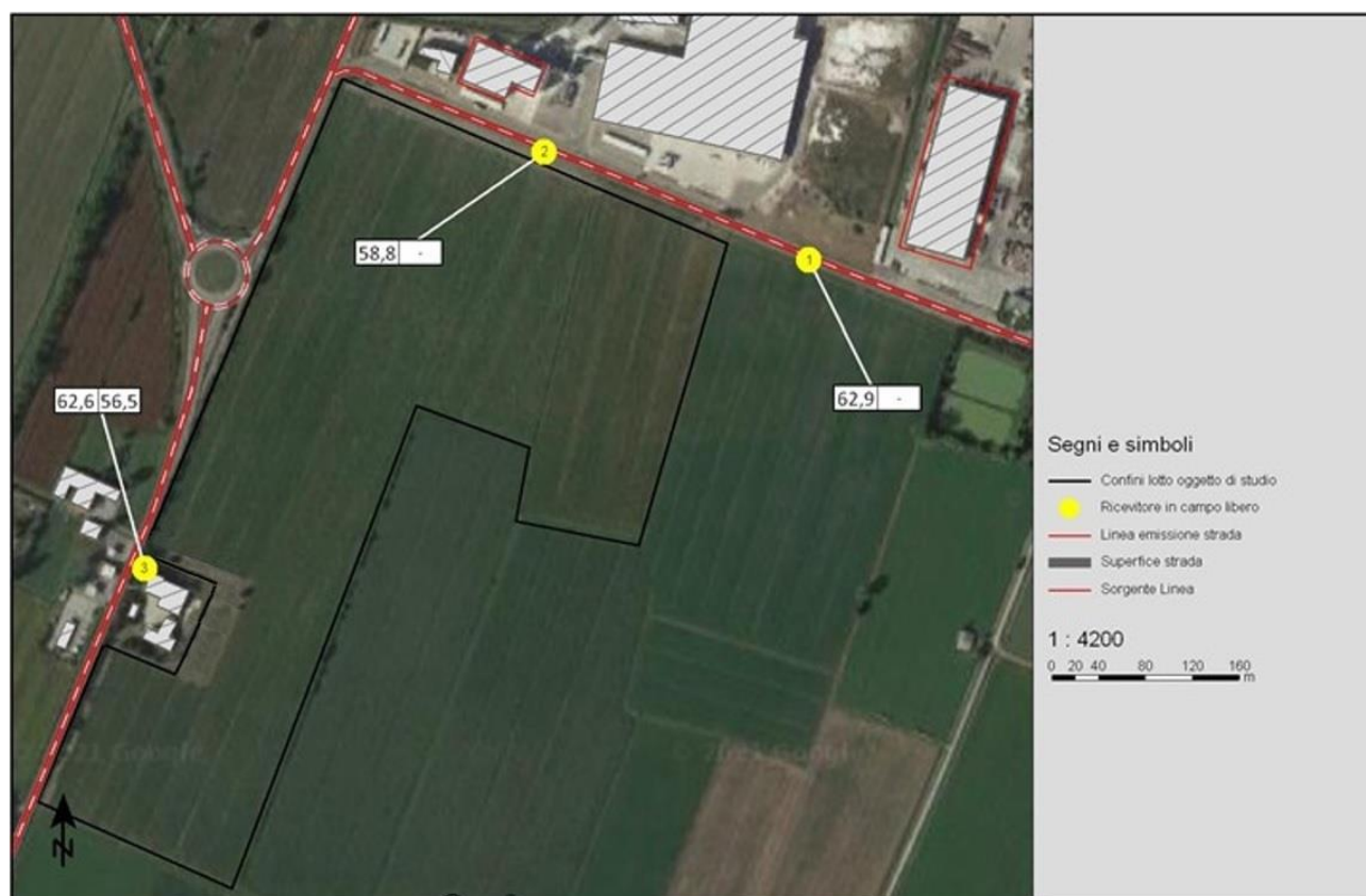
Figura 24 - Simulazione software ante operam (mappatura, punti singoli)
