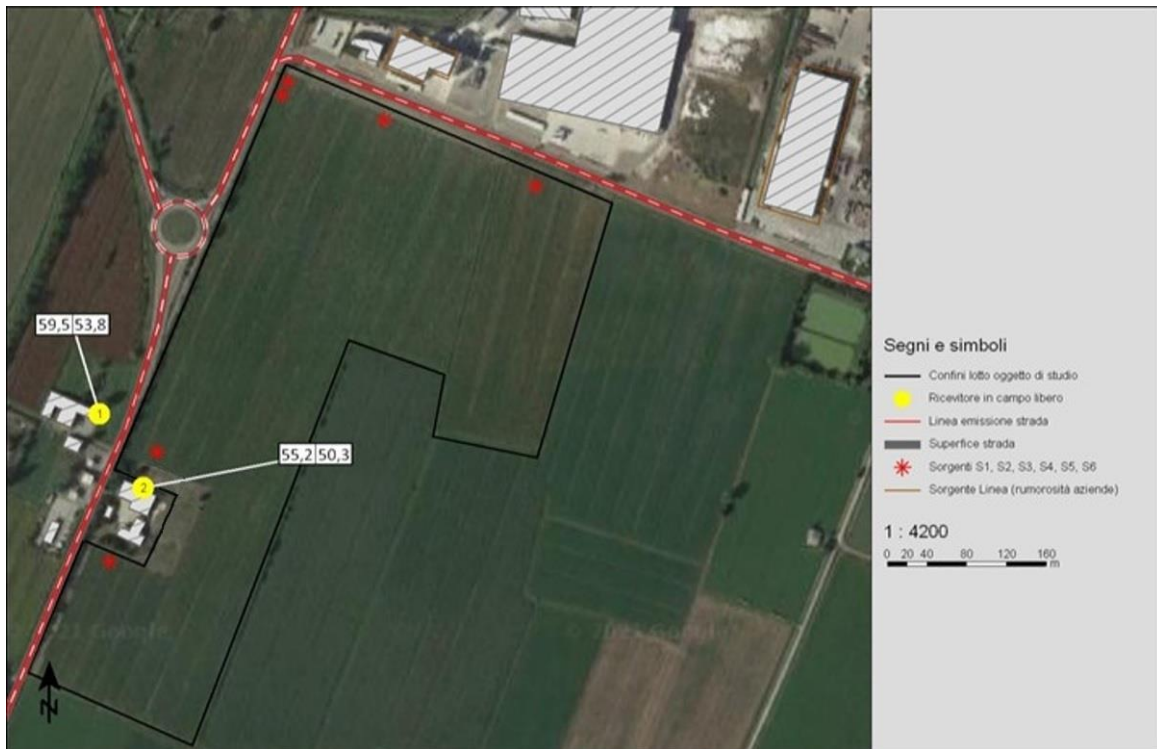
Figura 35 - Simulazione software (analisi punti singoli, post operam Ambientale con area industriale)
