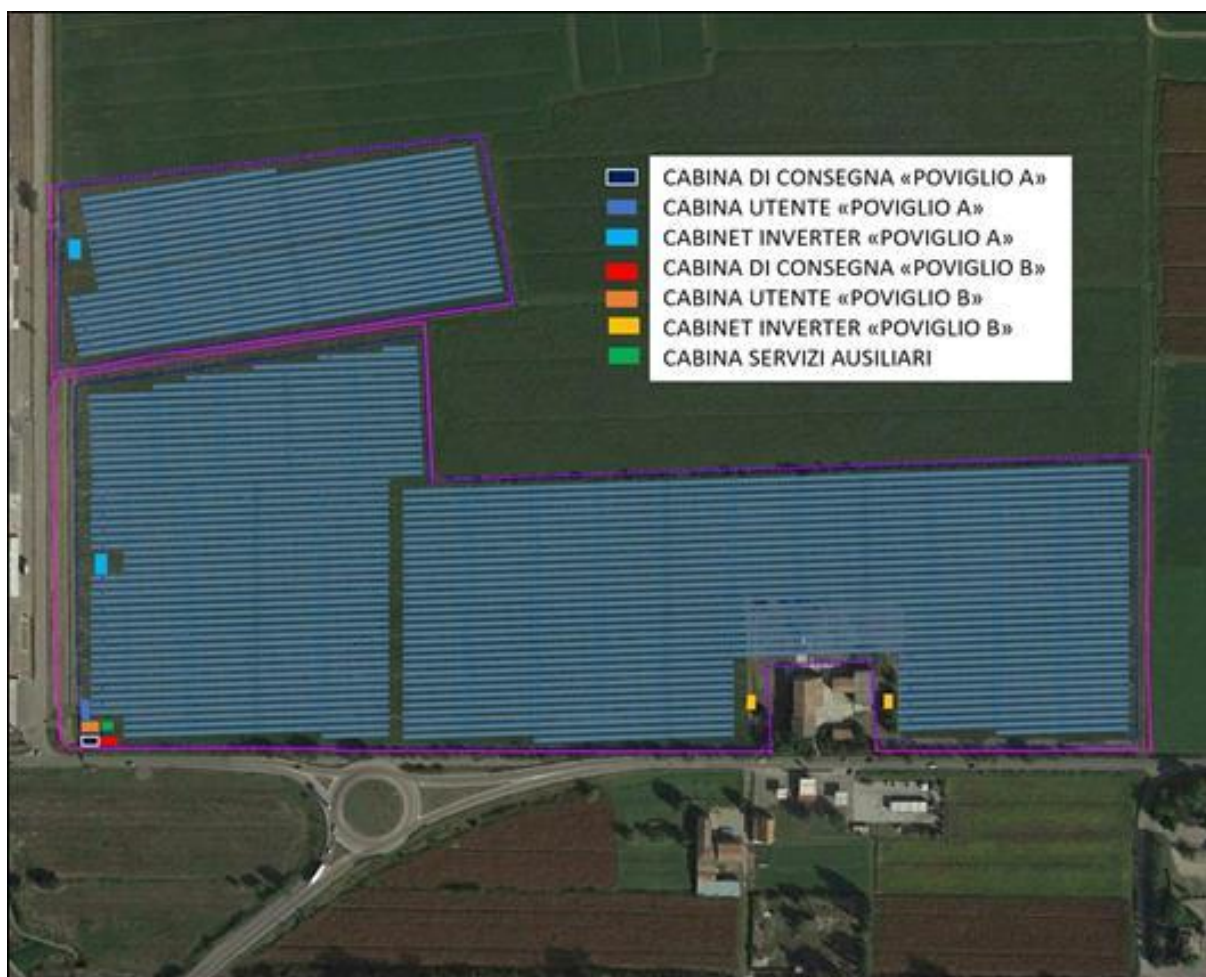
Figura 9 - Disposizione impianto all'interno del lotto
