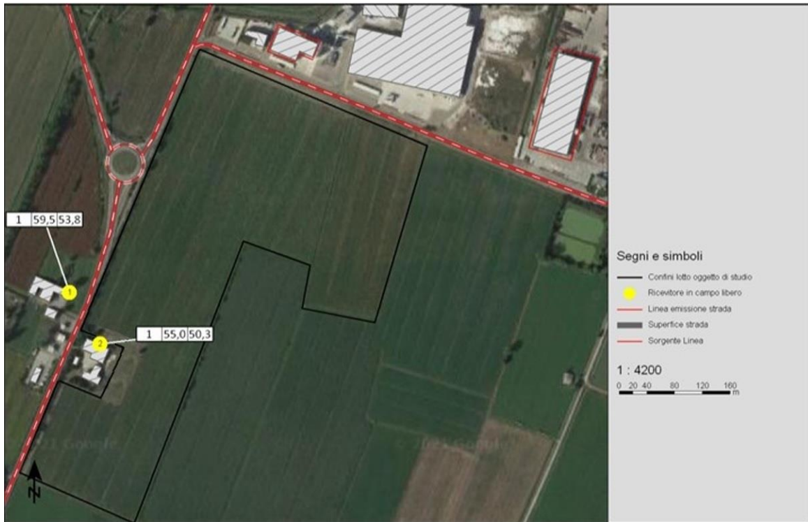
Figura 33 - Simulazione software (analisi punti singoli, Residuo con area industriale)
