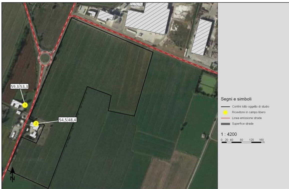
Figura 34 - Simulazione software (analisi punti singoli, Residuo senza area industriale)
