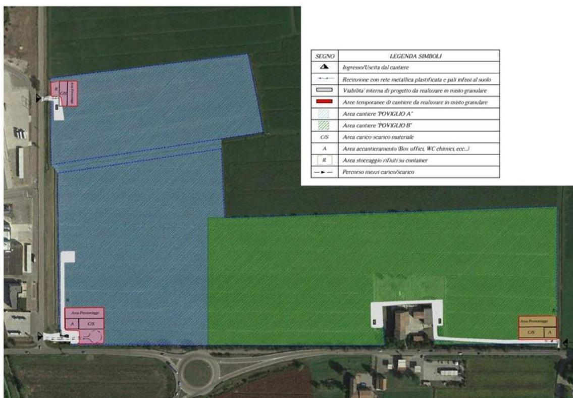
Figura 2-5 – Area di cantiere per la realizzazione del campo fotovoltaico
