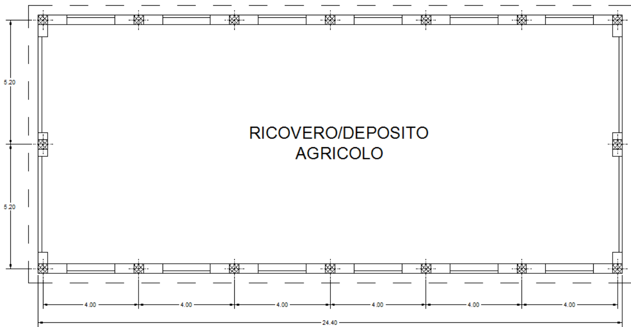
Figura 20: Pianta edificio ricovero mezzi agricoli
