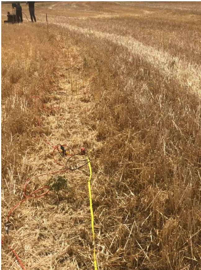
Foto Stendimento di sismica a masw Mw1.
