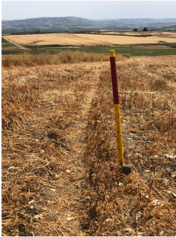
Foto Stendimento di sismica a rifrazione Rz3.
