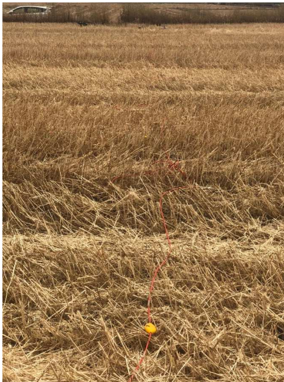
Foto Stendimento di sismica a rifrazione Rz2.
