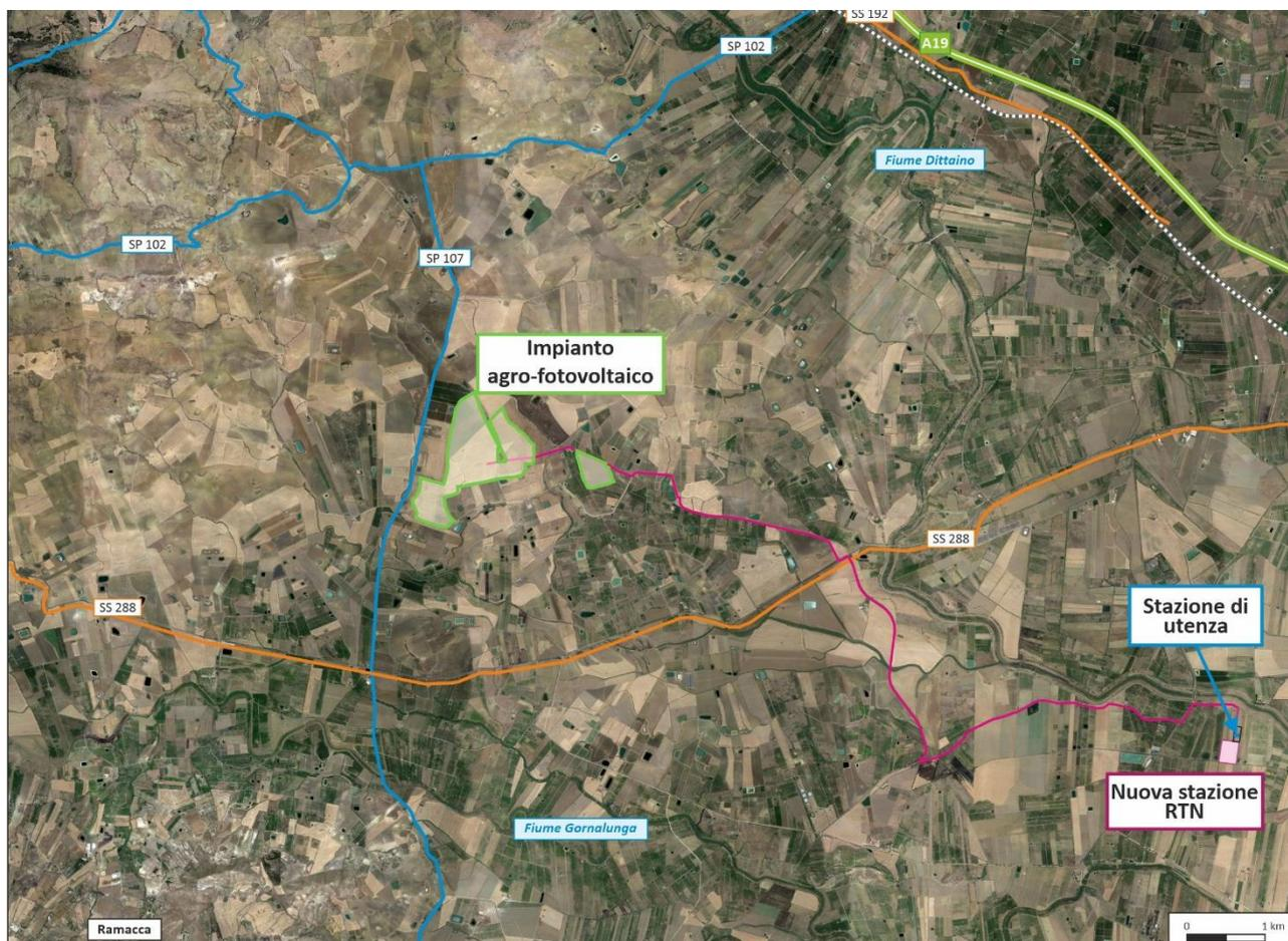
**Figura 4-Lay out generale impianto agro-fotovoltaico e relative opere connesse**
