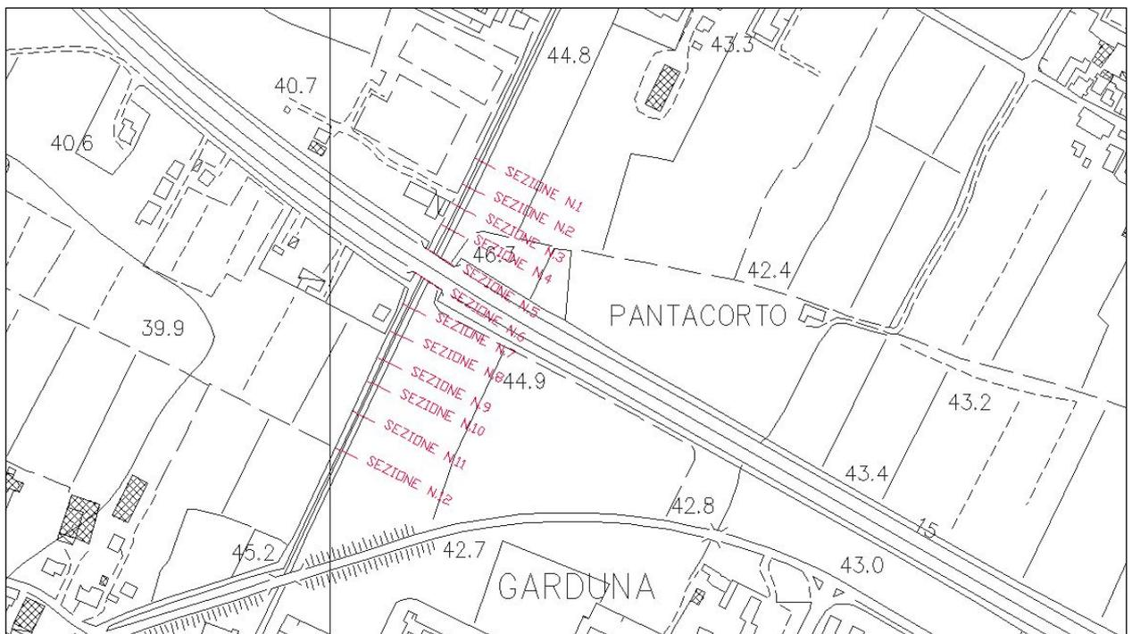
**Figura 22 - Stralcio cartografico del tratto di corso d'acqua simulato con la rappresentazione planimetrica delle sezioni di rilievo utilizzate nel modello di simulazione.**
