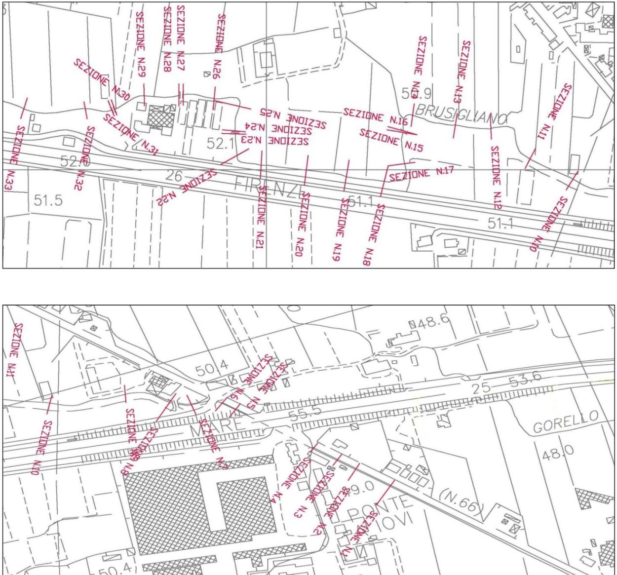
**Figura 47 - Stralci cartografici del tratto di corso d'acqua simulato con la rappresentazione planimetrica delle sezioni di rilievo utilizzate nel modello di simulazione.**
