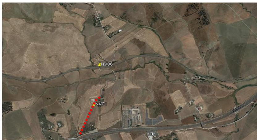
Per consentire la risoluzione dell'interferenza, è prevista una leggera traslazione verso est della strada, in modo da superare la linea in progetto; il progetto ha previsto anche un leggero spostamento dell'innesto sulla contrada Anghilla, in modo da garantire un angolo tra gli assi superiore a 70°. Detta soluzione fuori sede, consente anche l'esecuzione dell'opera senza prevedere alcuna interruzione del traffico veicolare.
