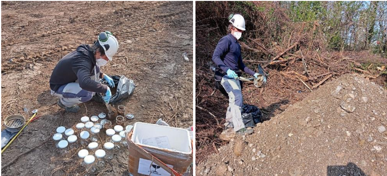
Figura 6—A: A sinistra fase di omogenizzazione e formazione campioni; A Destra il prelievo e la setacciatura in cumulo.
