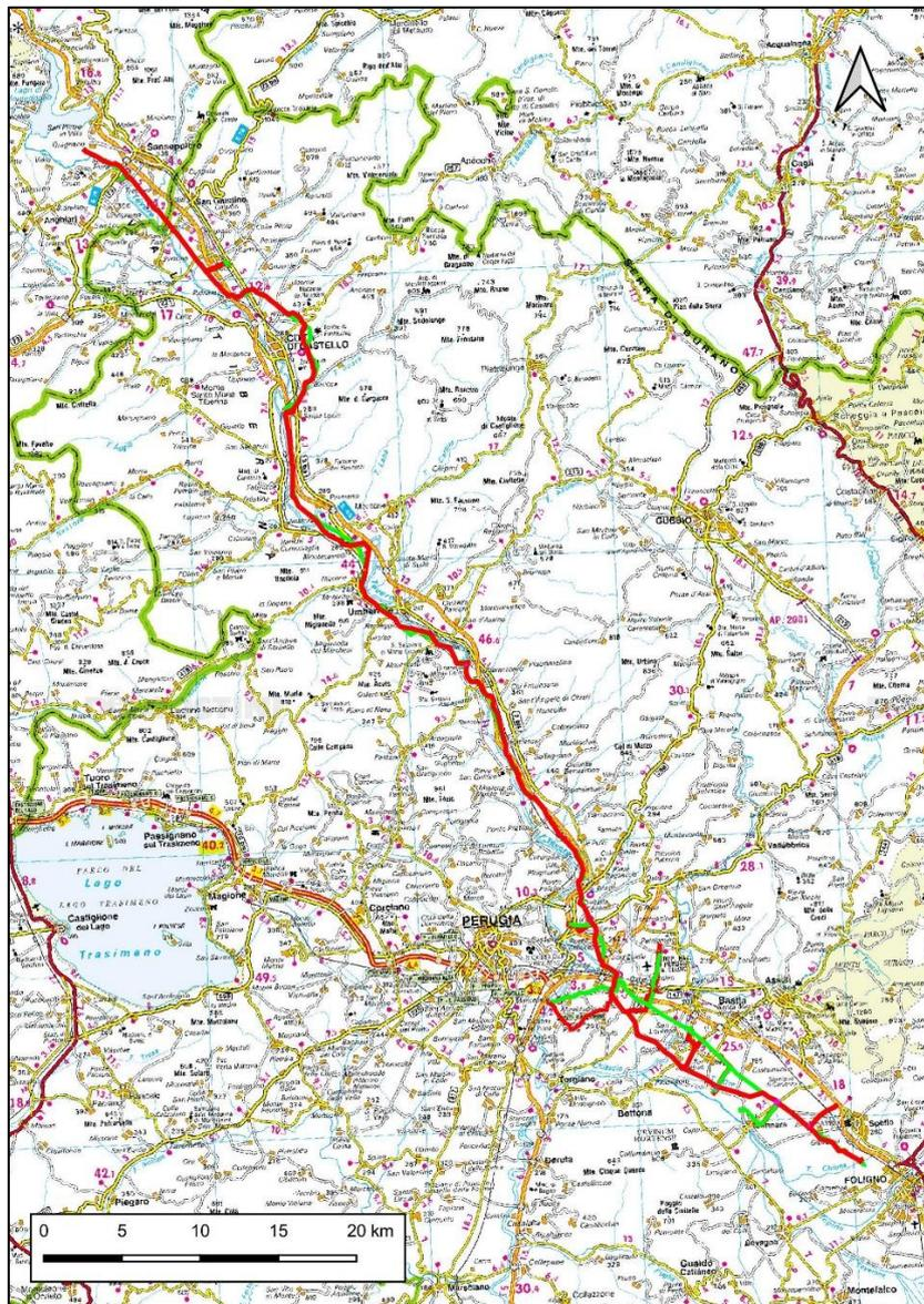
Figura 4/1 – Localizzazione delle opere (in rosso linee in progetto, in verde linee in dismissione)
