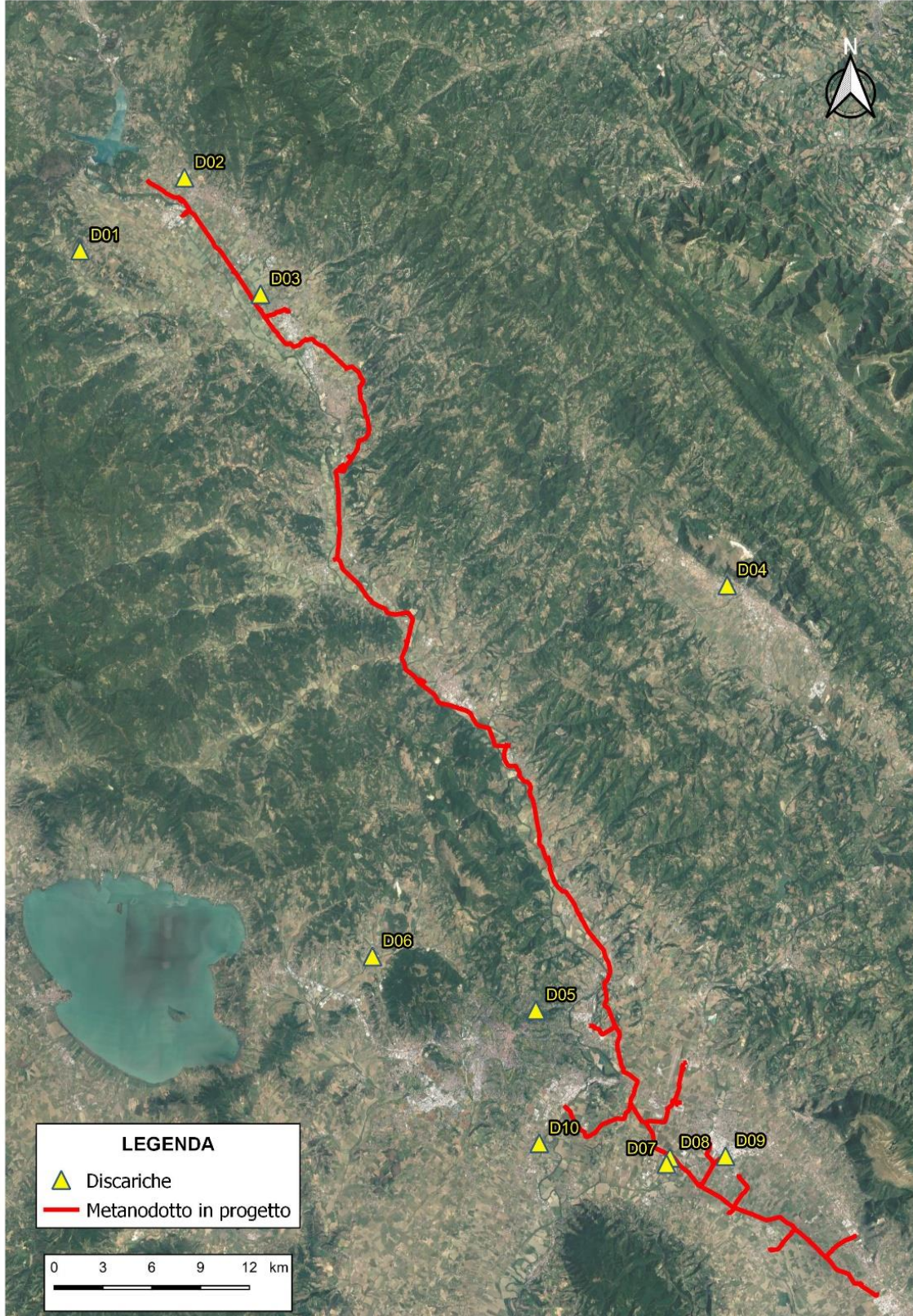
Figura 4/A: Inquadramento discariche/siti di smaltimento localizzate in prossimità dell'area oggetto di intervento, selezionate per il conferimento dello smarino derivante da opere trenchless
