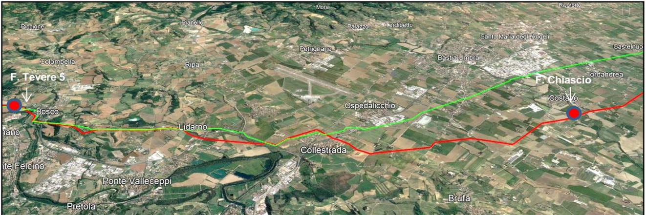
**Figura 5/F1 – Vista aerea 3D del tratto in esame** - Linea rossa tracciato in progetto, verde condotta in dismissione
