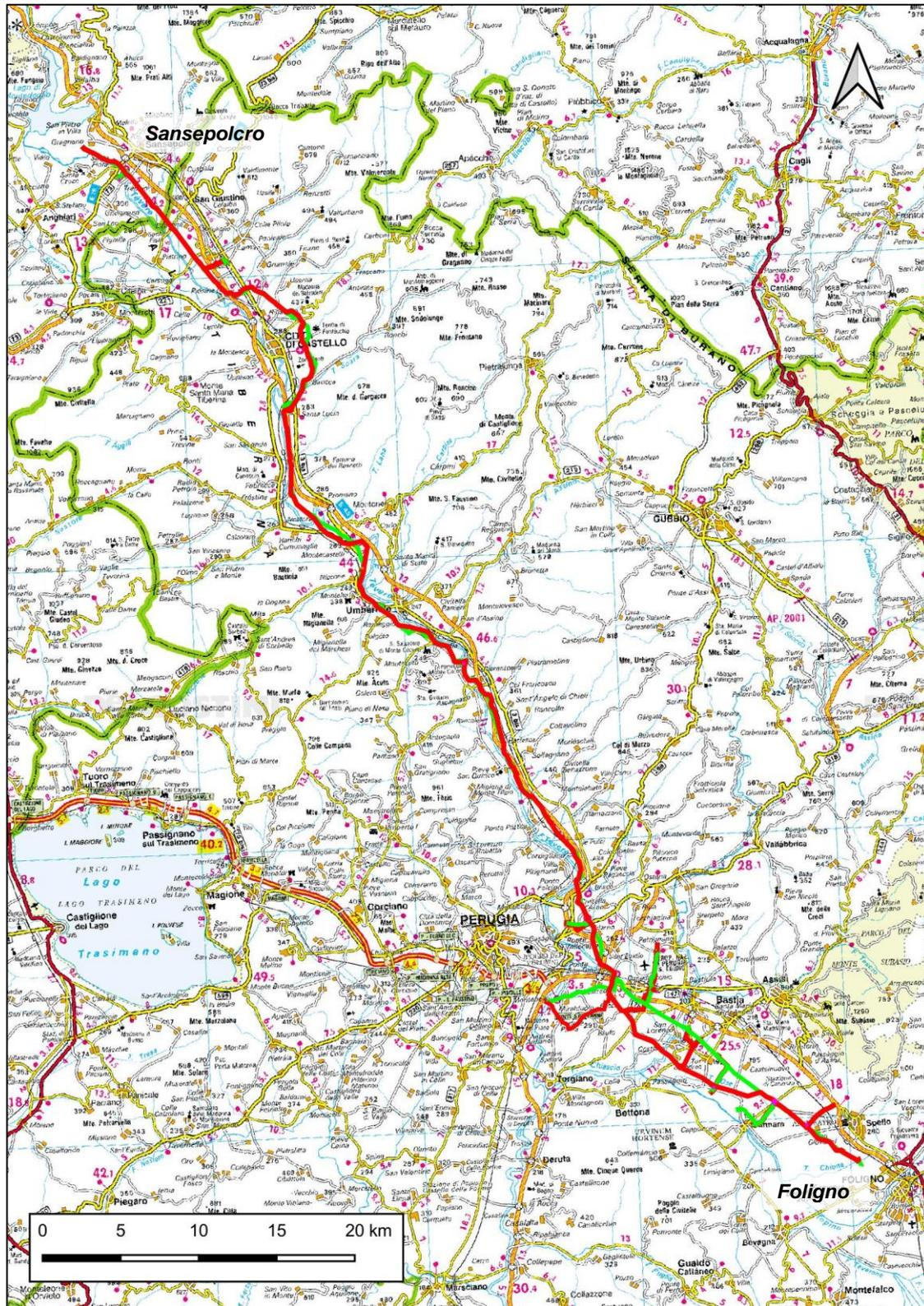
Figura 0/A: Corografia (Linea rossa tracciato metanodotti in progetto, linea verde metanodotti da dismettere)
