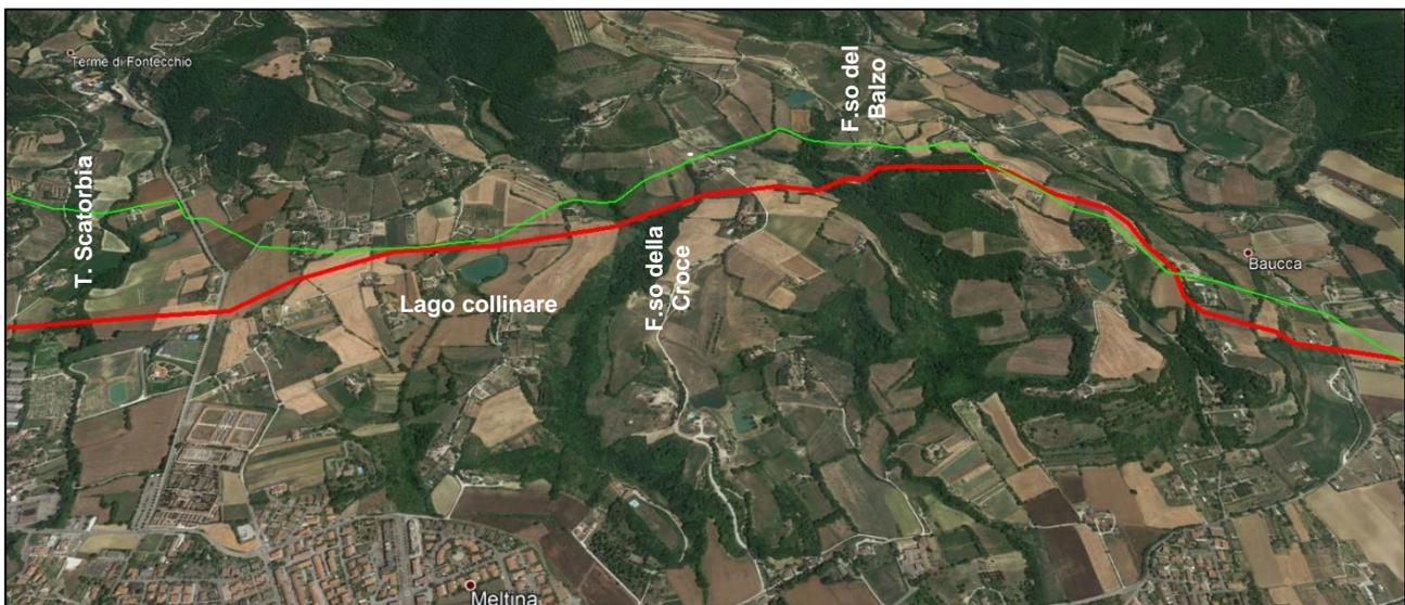
**Figura 5/B6 – Attraversamento zona collinare a tergo di Città di Castello - Linea rossa tracciato in progetto, verde condotta in dismissione**
