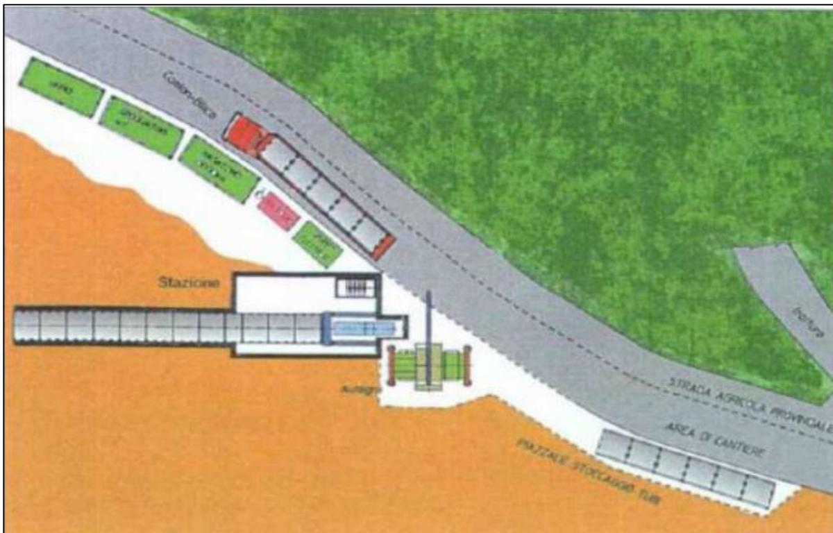
Figura 7.1.12.2/B – Schema tipo di un cantiere per l'installazione di un microtunnel
