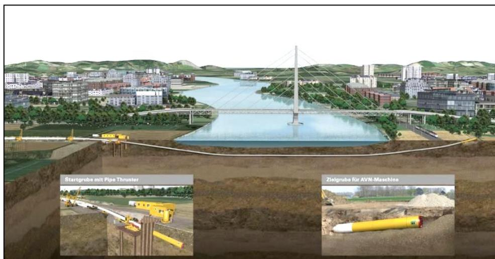
Figura 7.1.12.3/A– Schema della metodologia Direct Pipe
