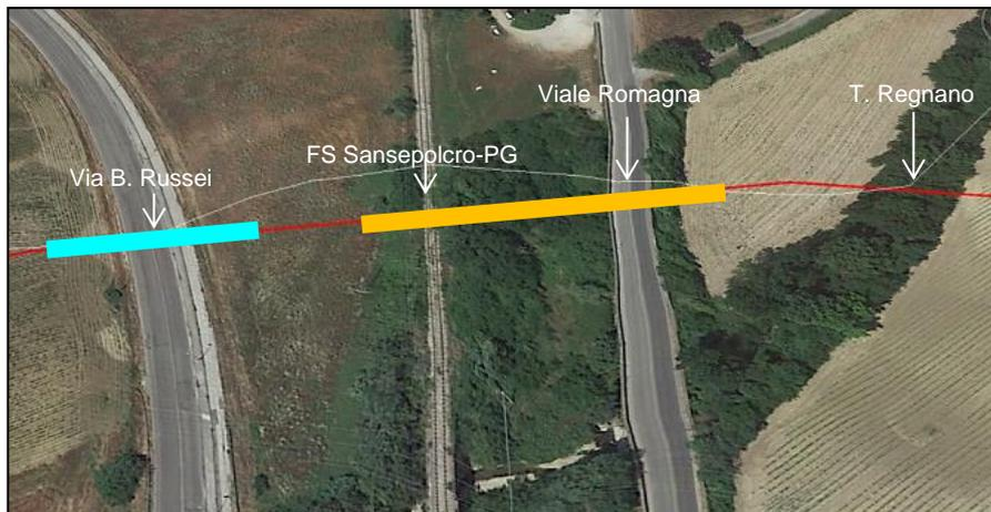
Figura 5/B2 – Immagine aerea dell'attraversamento multiplo. In azzurro 1° trivellazione in giallo 2° trivellazione
