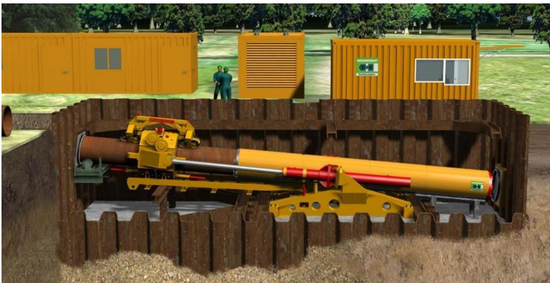
**Figura 7.1.12.3/C – Particolare della colonna di varo spinta tramite il pipe thruster**
