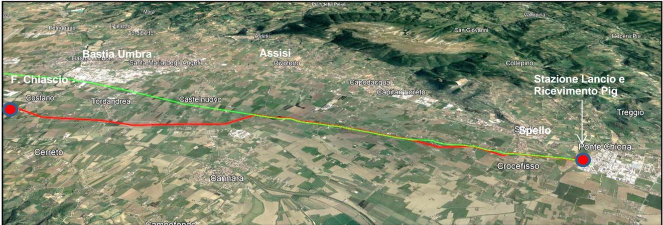
Figura 5/G1 – Vista aerea 3D del tratto in esame - Linea rossa tracciato in progetto, verde condotta in dismissione
