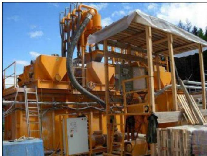
Figura 7.1.12.2/D – Sistema di disidratazione
