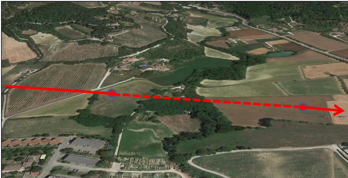
**Figura 5/B5 – Vista dell’attraversamento del Torrente Scatorbia. Linea tratteggiata TOC**
