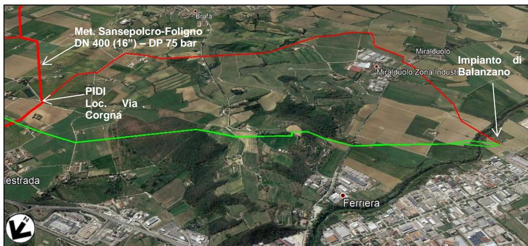
Figura 7—NN: Vista aerea 3D del tracciato in esame (da Google Earth) (in verde i metanodotti esistenti da dismettere, in rosso tracciati di fattibilità in magenta le varianti)
