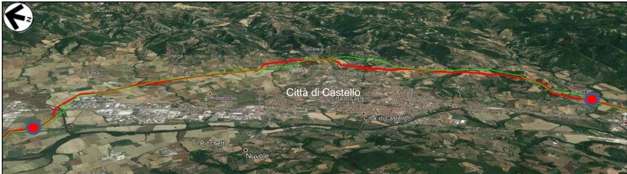
**Figura 7—D: Vista aerea 3D del tratto in esame (da Google Earth) linea rossa tracciato in progetto, verde condotta in dismissione**
