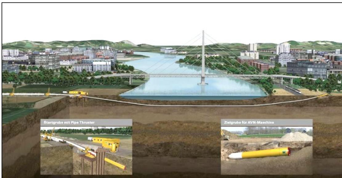
Figura 7—WW: Schema della metodologia Direct Pipe
