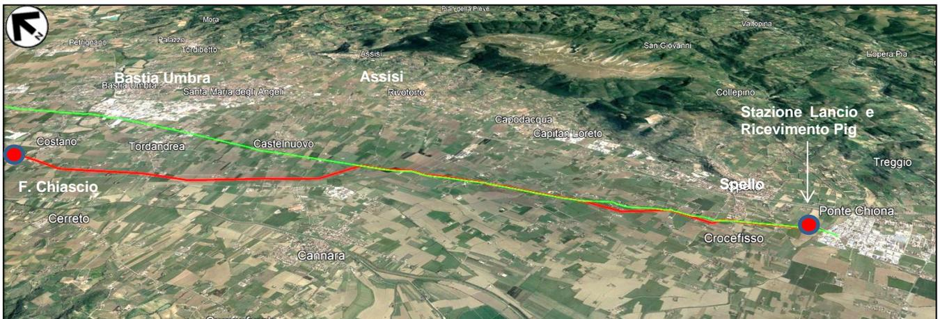
**Figura 7—MM: Vista aerea 3D del tratto in esame (da Google Earth) Linea rossa tracciato in progetto, verde condotta in dismissione**
