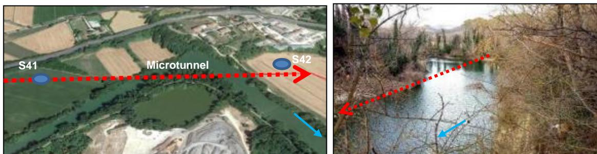
Figura 7—EE: Attraversamento trenchless F. Tevere 5
