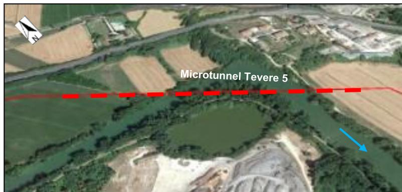
Figura 3.1/M - Vista dell'attraversamento Tevere 5 in trenchless
