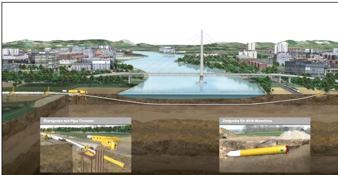
Figura 7.5.2/A– Schema della metodologia Direct Pipe
