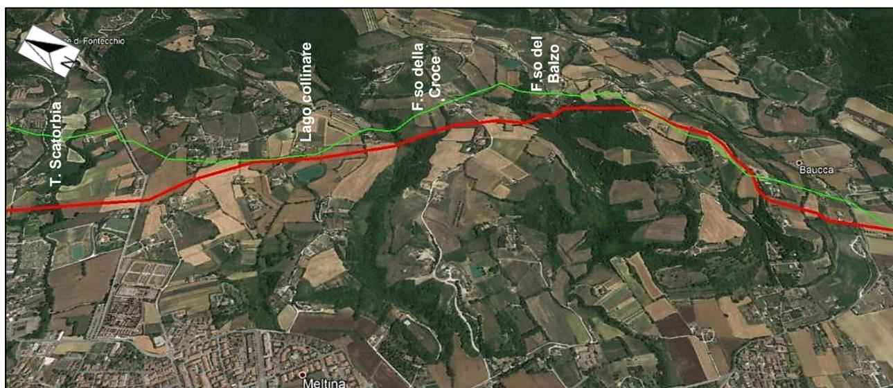
**Figura 3.1/C - Attraversamento zona collinare a tergo di Città di Castello** - Linea rossa tracciato in progetto, verde condotta in dismissione
