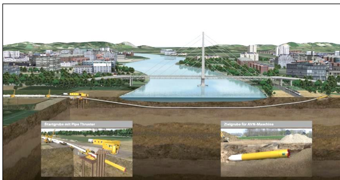
Figura 5.1.3/A– Schema della metodologia Direct Pipe
