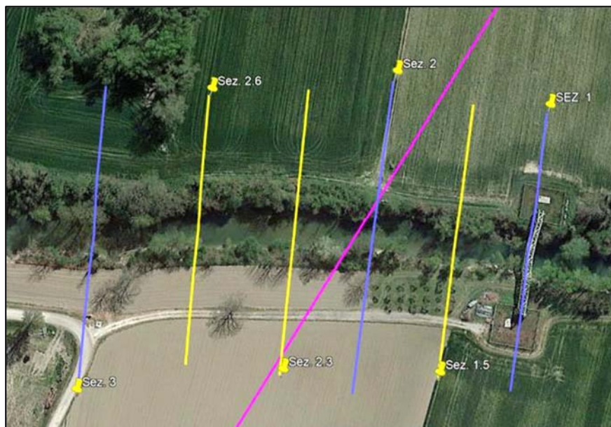
Figura 4.4.2/A – Immagine aerea del tratto di corso modellato con riportate le sezioni di studio (in blu sezioni rilevate, in giallo interpolate)
