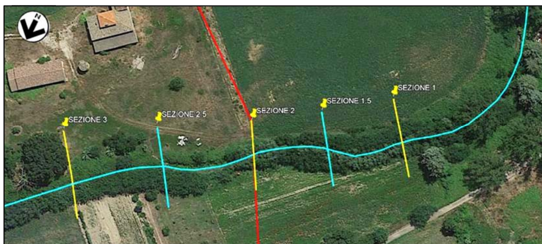
Figura 4.4.2/A – Stralcio della mappa con riportate le sezioni di modellazione idraulica locale (in giallo sezioni rilevate, in azzurro sezioni interpolate)
