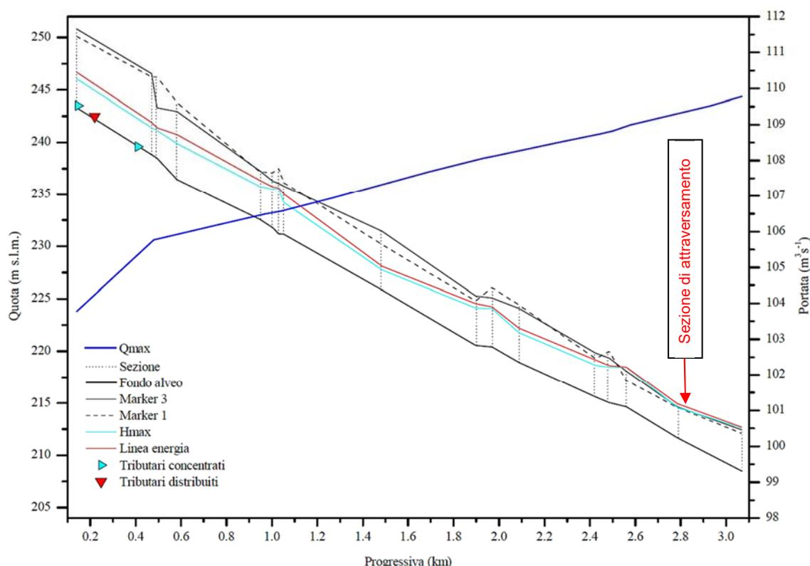
**Figura 4.1/B – Involuppo dei massimi livelli calcolati per l'evento di piena con tempo di ritorno 200 anni. E' riportata anche la geometria dell'alveo.**
