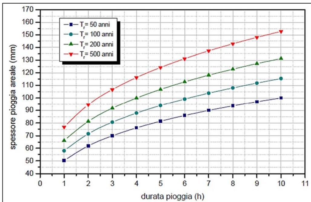
Figura 3/A – Linee segnalatrici di possibilità pluviometrica per il bacino del T. Resina (da studio CNR-IRPI)
