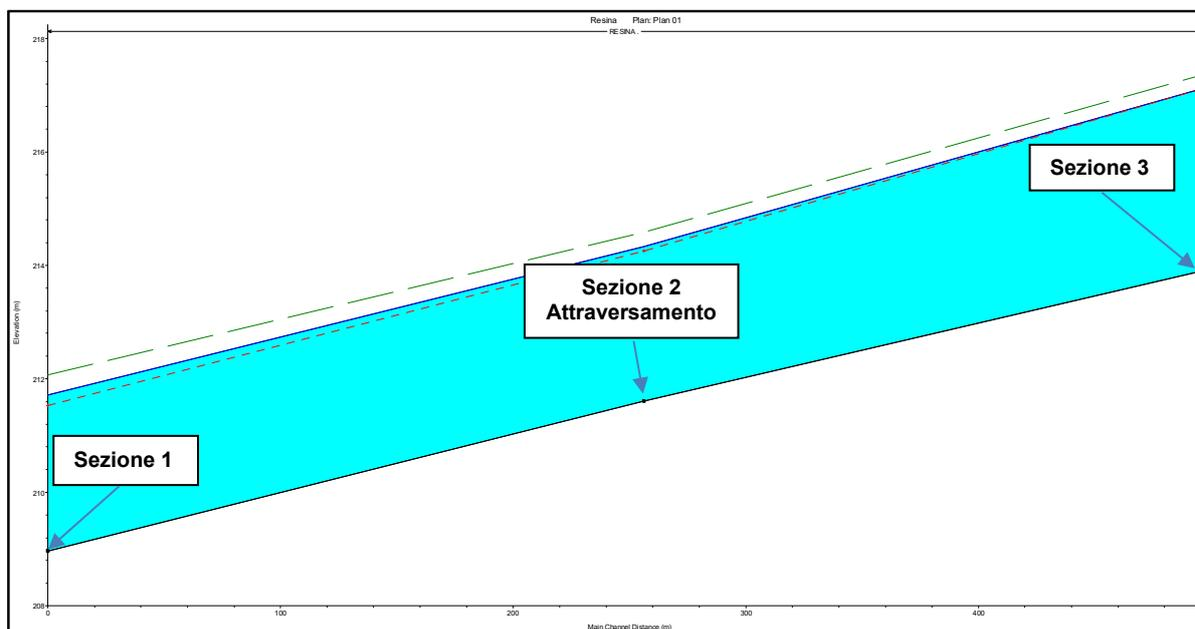
**Figura 4.3.3/A – Profilo longitudinale con livello idrico duecentennale**
