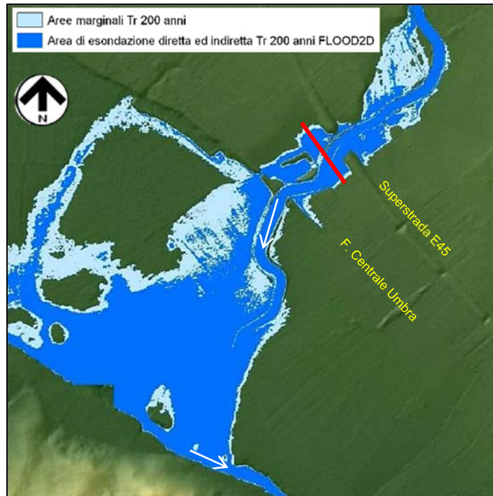
Figura 4.3/B - Mappa delle aree di esondazione per Tr=200 anni calcolate con modello bidimensionale (linea rossa: sezione di attraversamento)
