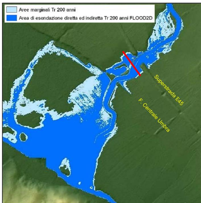
Figura 4.1/C - Mappa delle aree di esondazione per  $Tr=200$  anni calcolate con modellazione bidimensionale (linea rossa: sezione di attraversamento)
