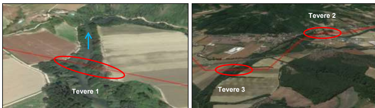
Figura 11 Vista degli attraversamenti Tevere 1 in TOC e Tevere 2 e Tevere 3 in trenchless (da Google Earth)
