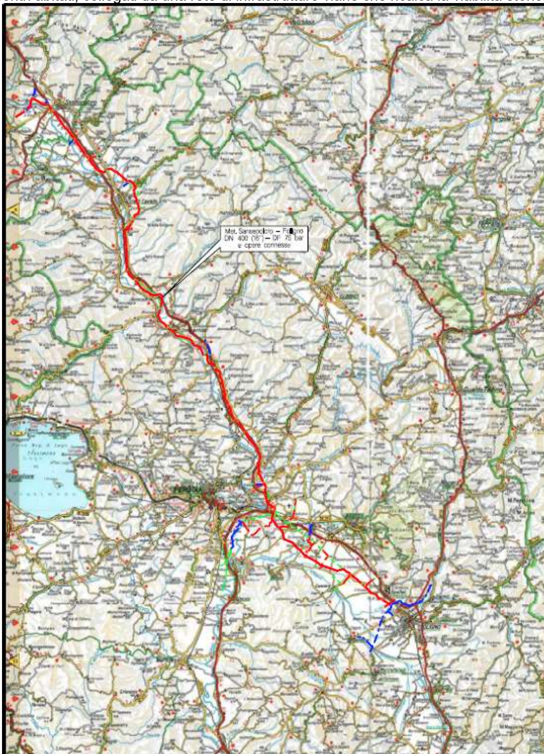
Figura 3 Corografia a scala 1:400.000 (Linea rossa tracciato metanodotti in progetto, linea blu metanodotti in esercizio, linea verde metanodotti da dismettere).
