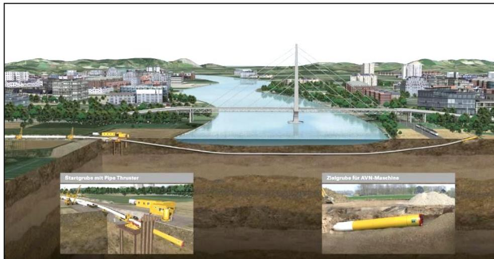
Figura 2-9: Schema della metodologia Direct Pipe
