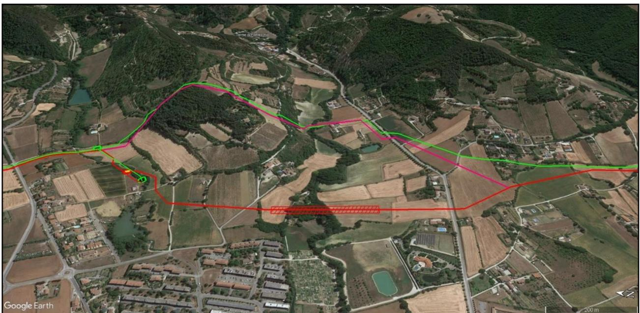
**Figura 2-4: Vista aerea Poggio San Benedetto tracciato di progetto definitiva (linea rossa), tracciato alternativo (linea magenta) e metanodotti in dismissione (linee verdi)**
