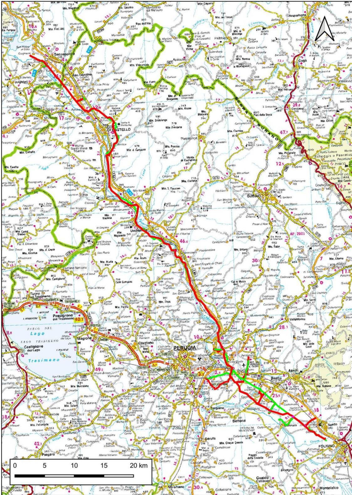
Figura 2-1: Corografia (Linea rossa tracciato metanodotti in progetto, linea verde metanodotti da dismettere).
