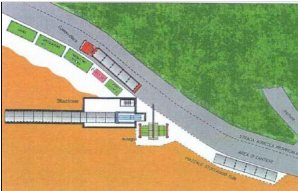
**Figura 2-22: Schema tipo di un cantiere per l'installazione di un microtunnel**
