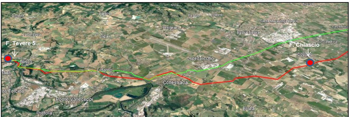
**Figura 3.4/F1 – Vista aerea 3D del tratto in esame – Linea rossa tracciato in progetto, verde condotta in dismissione**
