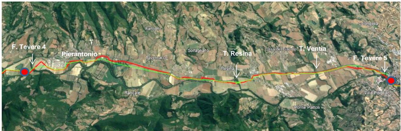
**Figura 3.4/E1 – Vista aerea 3D del tratto in esame** - Linea rossa tracciato in progetto, verde condotta in dismissione
