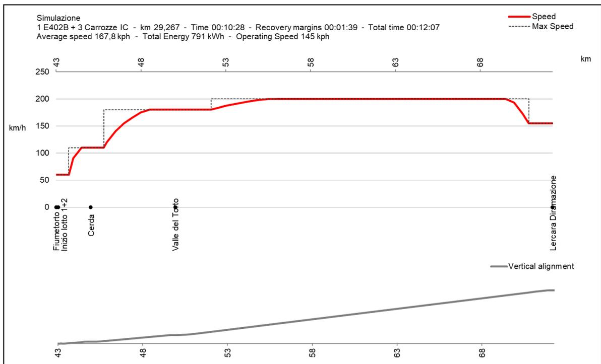
**Figura 24: Diagramma di marcia Servizio Intercity Palermo – Catania della tratta Fiumetorto - Lercara Diramazione (Lotto 1+2) come da scenario di progetto in Prima Macrofase Funzionale.**
