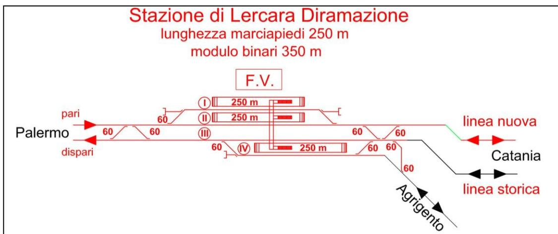
**Figura 19: Layout funzionale di progetto – Stazione di Lercara Diramazione**
