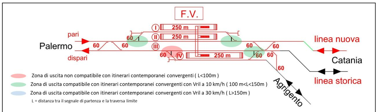
**Figura 20: Layout funzionale di progetto –Stazione di Lercara– Itinerari contemporanei convergenti**
