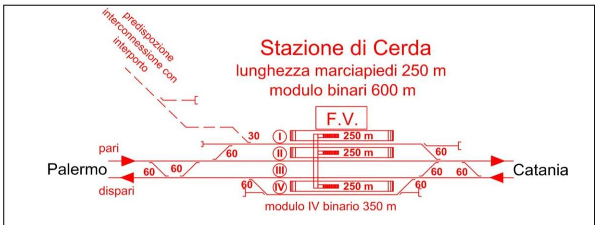
Figura 17: Layout funzionale di progetto – Stazione di Cerda
