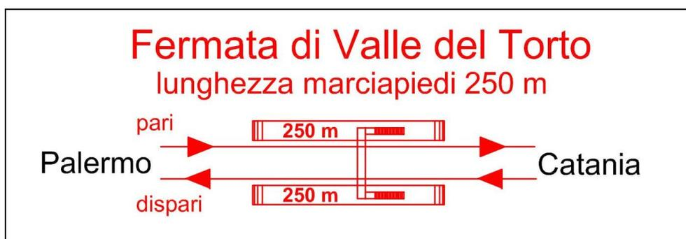
**Figura 18: Layout funzionale di progetto – Fermata di Valle del Torto**
