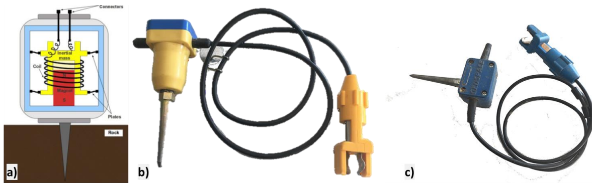
Figura 5 – Geofoni per onda P ed Sh; a) schema di funzionamento del geofono per onda P; b) geofono per onda P con frequenza caratteristica di 4.5 Hz; c) geofono per onda S con frequenza caratteristica di 8 Hz (utilizzato esclusivamente per la sismica a rifrazione).
