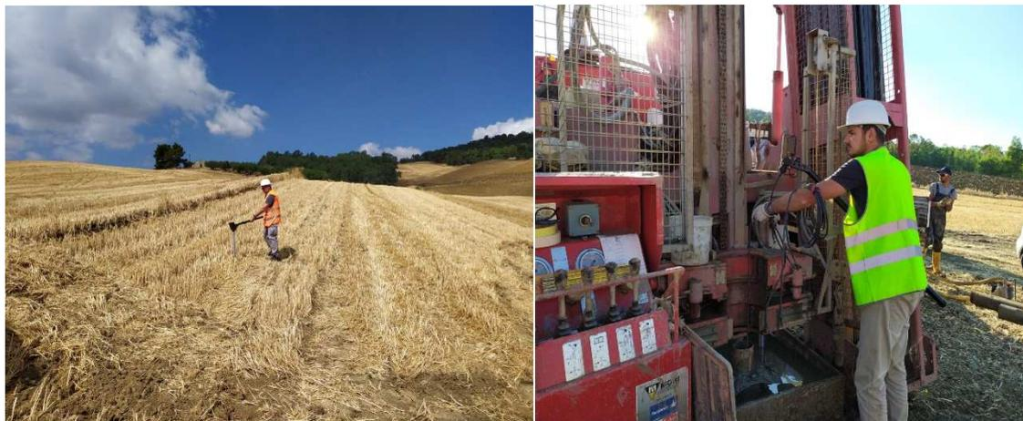
Figura 1: – Esecuzione di ricerca di masse metalliche superficiali e in foro mediante magnetometro MAGNEX della VOLTA.
