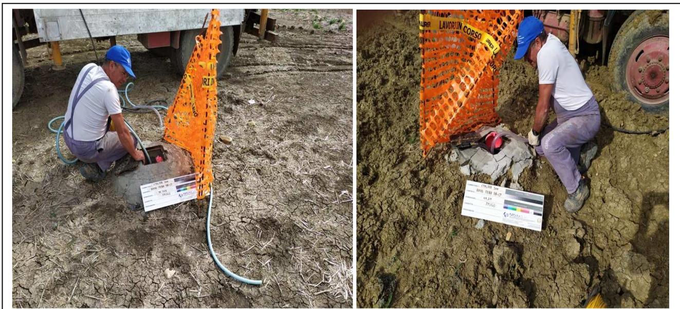
Foto 5– Spurgo piezometri casagrande mediante metodo air lift.
