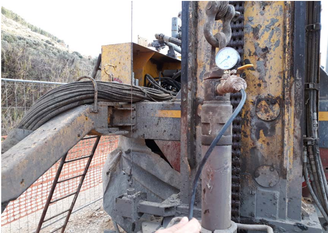
2SGN12BIS: Installazione rubinetto e manometro per misurazione GAS
