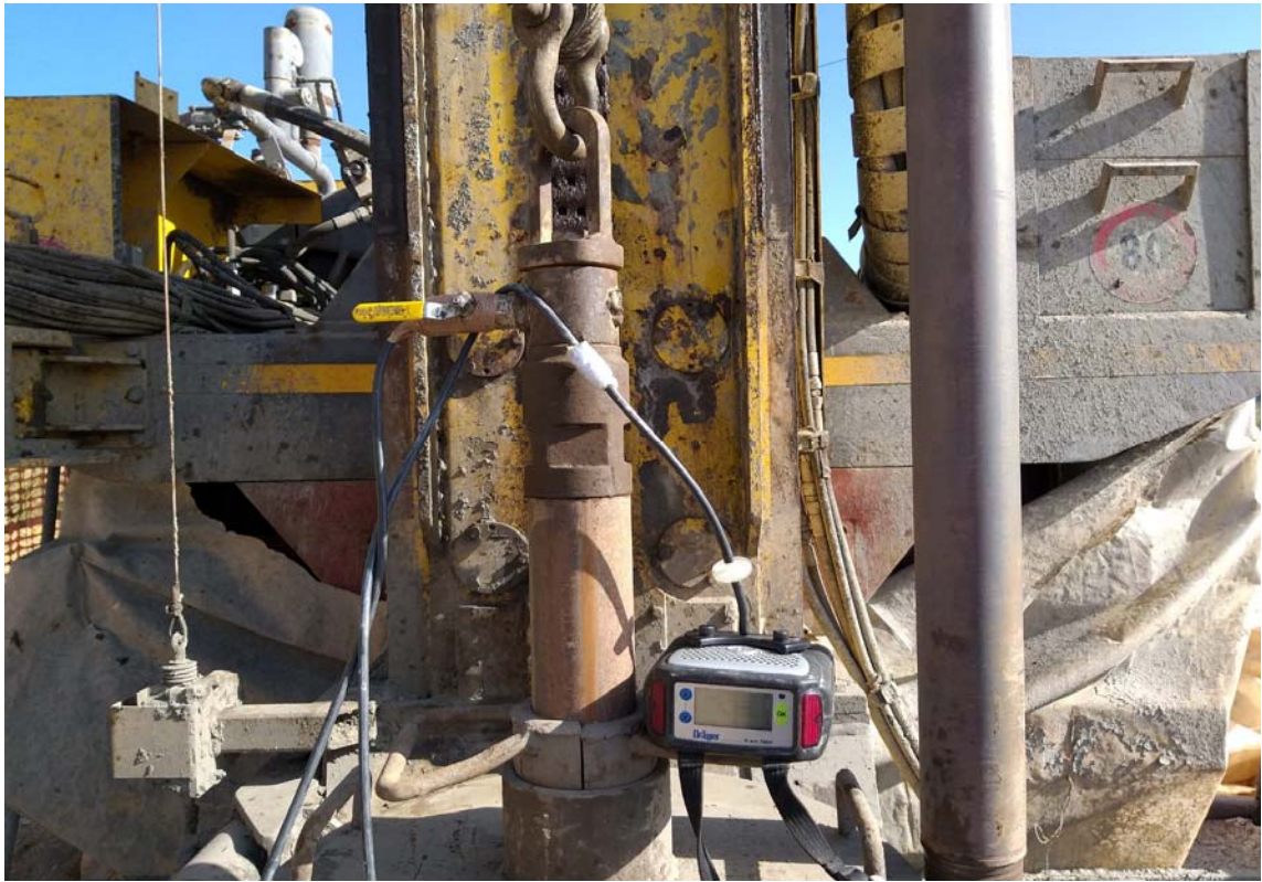
2SGN12BIS: Installazione rubinetto e manometro per misurazione GAS
