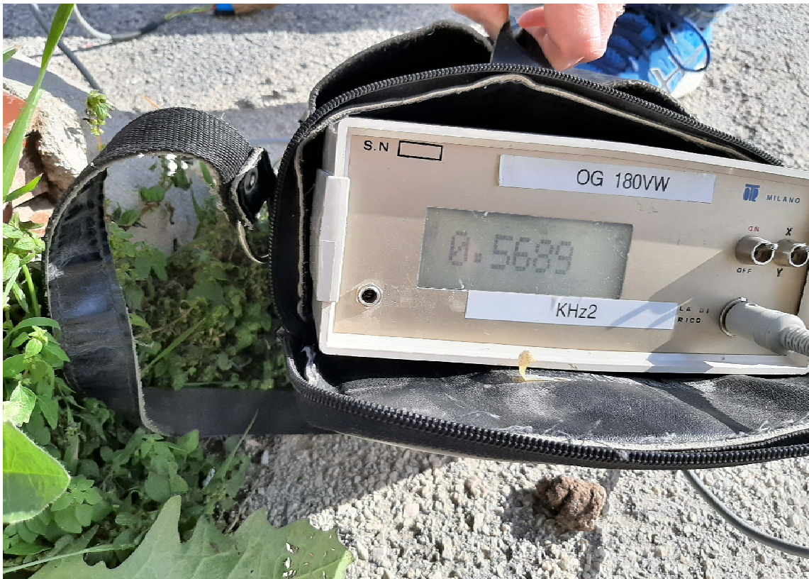
2SGN12BIS: Fase prima lettura Piezometro Corda Vibrante
