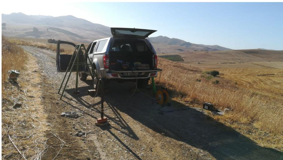
Fig. 5: ESECUZIONE PROVA DOWNHOLE 2SNV23
