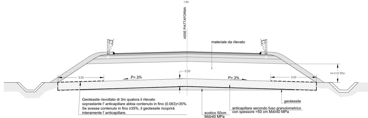
SEZIONE TIPO IN RILEVATO - 0.90m < Hr il < 1.10m
