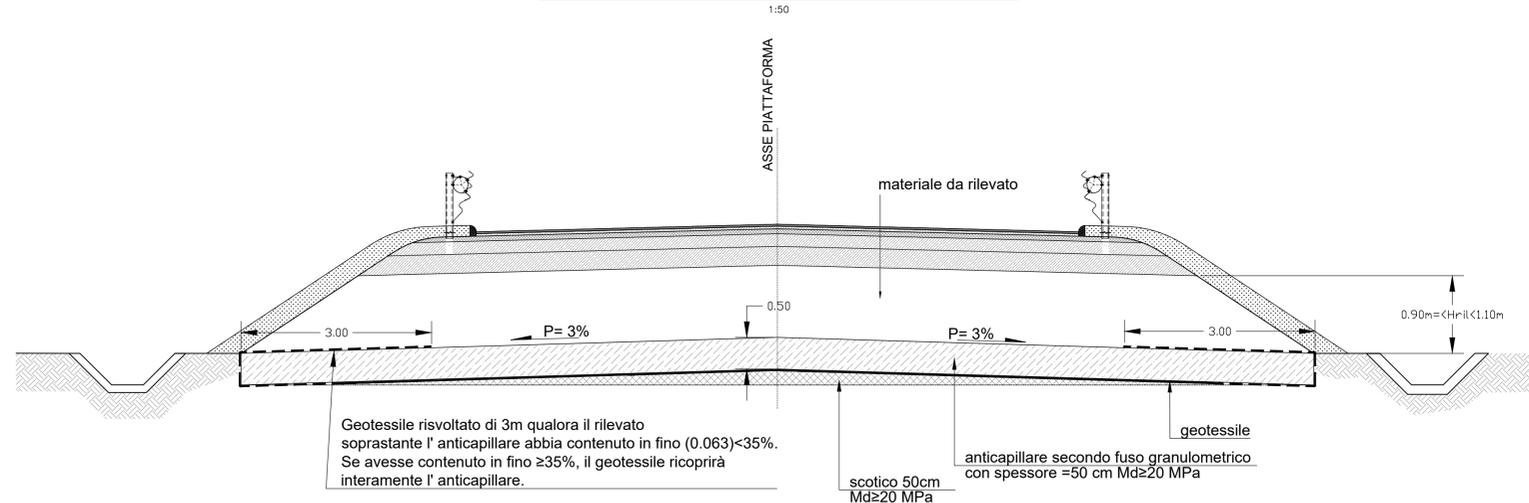
SEZIONE TIPO IN RILEVATO - Hr il > 1.10m
